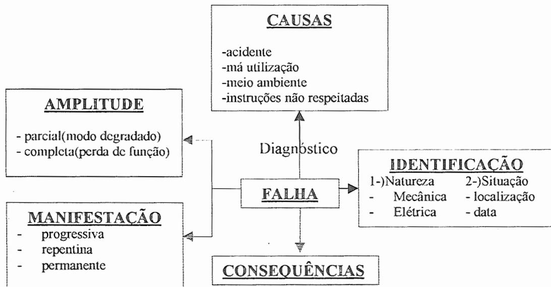
FIGURA 10 - Elementos para análise de uma falha (HELMAN et al.; 1995)
