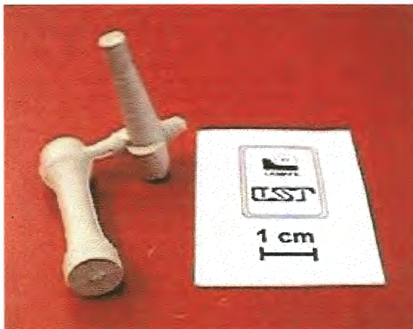
Figura 5.2. 7- Corpo de prova recém injetado com o canal de alimentação.
