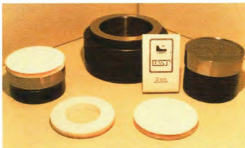
Figura 5.2. 8- Discos prensados e o molde empregado na sua obtenção.
