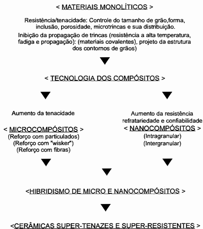
Figura 2.0. 1- Novo conceito de projetos no desenvolvimento de cerâmicas estruturais super resistentes e super tenazes NIIHARA (1991).
