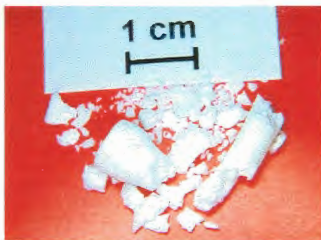
Figura 6.4. 5- Ilustração da fratura de um corpo de prova injetado.
