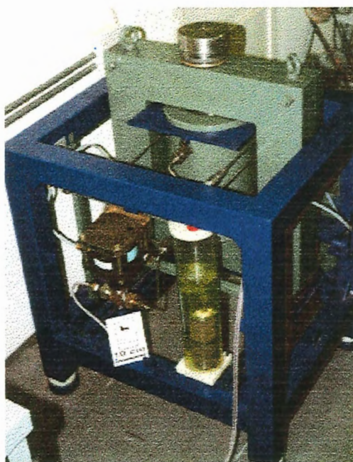
Figura 5.1. 10- Ilustração anterior da prensa destacando a montagem da unidade hidráulica da prensa isostática.
