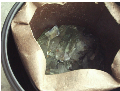
Figura 4.7 - Preparação da barrica de papel com vidro dentro da barrica preta plástica.
