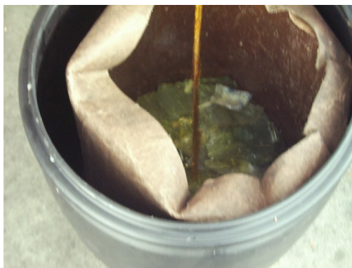
Figura 4.8 - Adição do álcool ao vidro dentro da barrica plástica imediatamente anterior à incineração da mesma.
