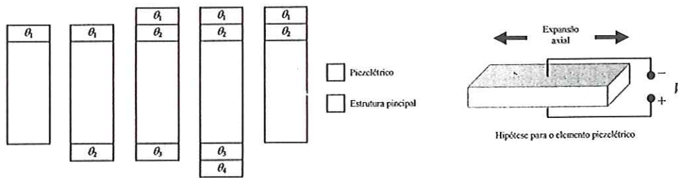
FIGURA 2.2 – Representação esquemática de alguns graus de liberdade elétricos.
