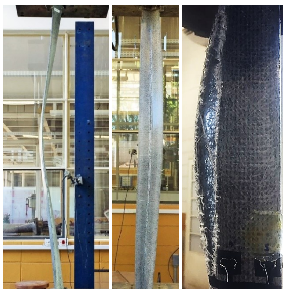
Figura 2.16 – Ruptura de cantoneira pultrudada com abertura das abas
