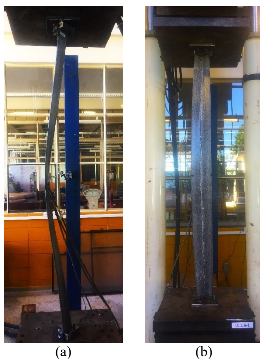
Figura 3.15 – Vista lateral (a) e frontal (b) do perfil LC.E.6-1 após à ruptura
