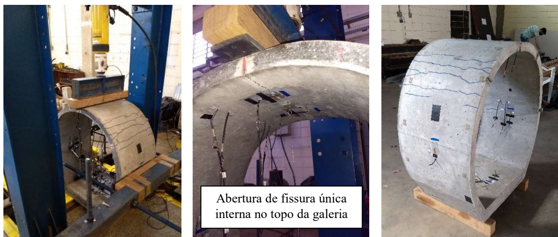
Figura 4.34 Fissuração no ensaio da galeria HPC com aplicação de carregamento vertical em 1 pontos
