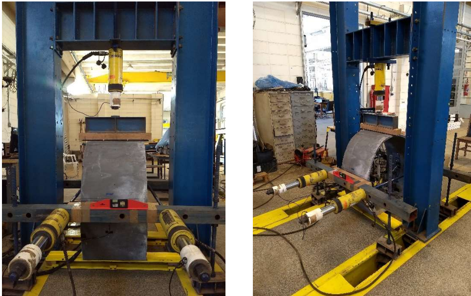
Figura 3.28 Montagem do ensaio com carregamento vertical concentrado em um ponto
