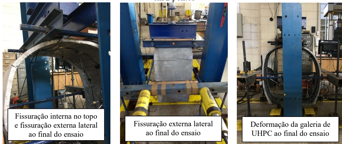
Figura 4.41 Padrão de fissuração no ensaio da galeria UHPC com aplicação de carregamento vertical em 2 pontos
