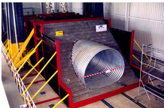
Figura 2.11 Vista do ensaio da galeria de aço corrugado
