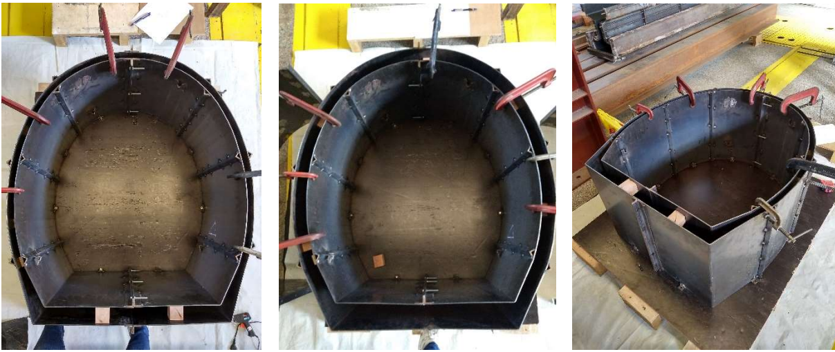
Figura 3.10 Forma metálica para a galeria definida por três arcos com duas espessuras
