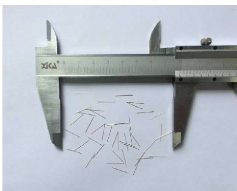
Figura 2.20 a) Microfibra revestida de cobre comprimento de 13 mm e diâmetro 0,2 mm b) ponta da fibra
