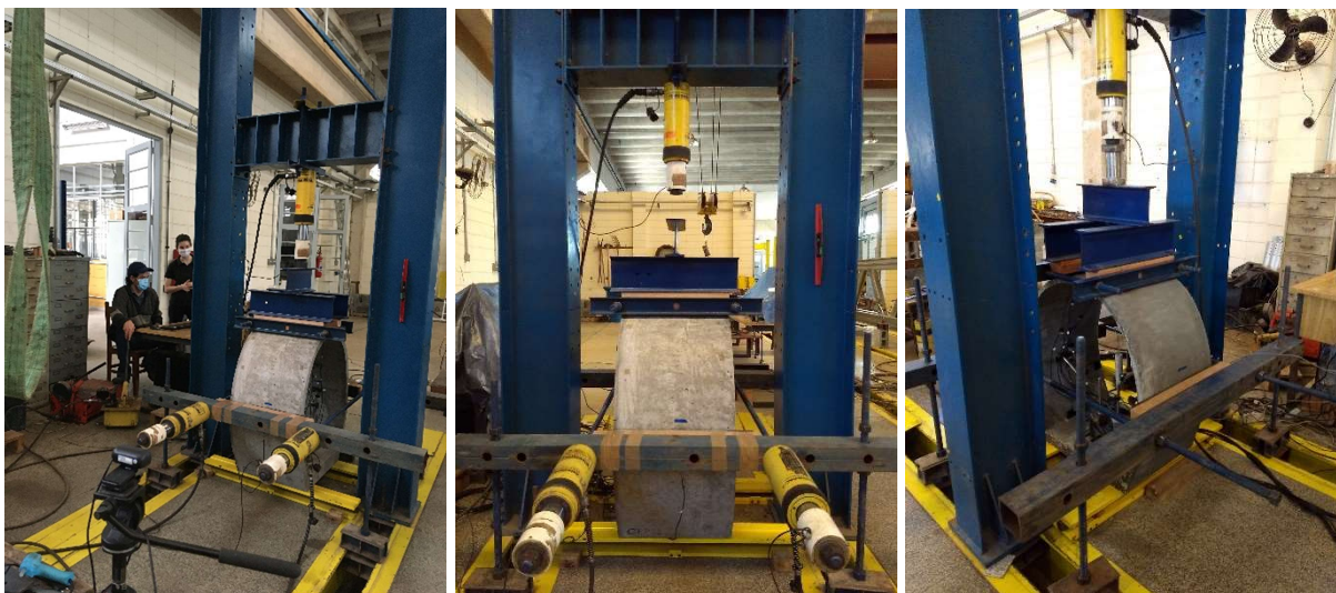
Figura 3.31 Montagem do ensaio com carregamento concentrado em quatro pontos (2V e 2H)
