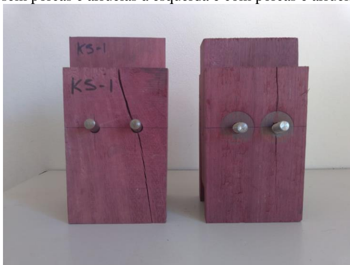
Figura 17 – Fendilhamento dos protótipos de ligação da espécie Roxinho e diâmetro igual a 12,5 mm: sem porcas e arruelas à esquerda e com porcas e arruelas à direita.
