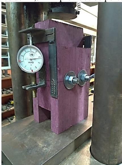
Figura 13 – Ensaio de protótipo de ligação da espécie Roxinho confeccionado para parafusos com diâmetros de 12,5 mm providos de porcas e arruelas.
