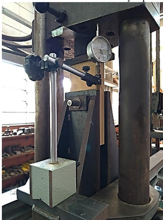
Figura 10 – Ensaio de embutimento na direção paralela às fibras.
