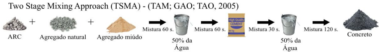
Figura 3.8 – Método de mistura adotado para as concretagens
