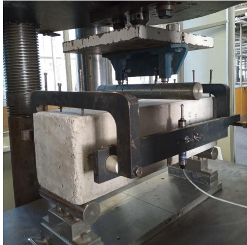
Figura 3.18 – Esquema de ensaio de flexão de prismas
