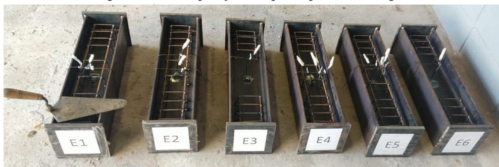
Figura 3.26 – Disposição dos perfis para concretagem
