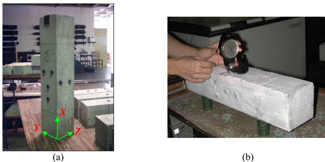
Figura 68. (a) Corpo-de-prova instrumentado com as bases do extensômetro mecânico; (b) Procedimento de leitura.
