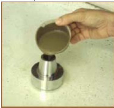
c) Preenchimento com pasta de cimento
