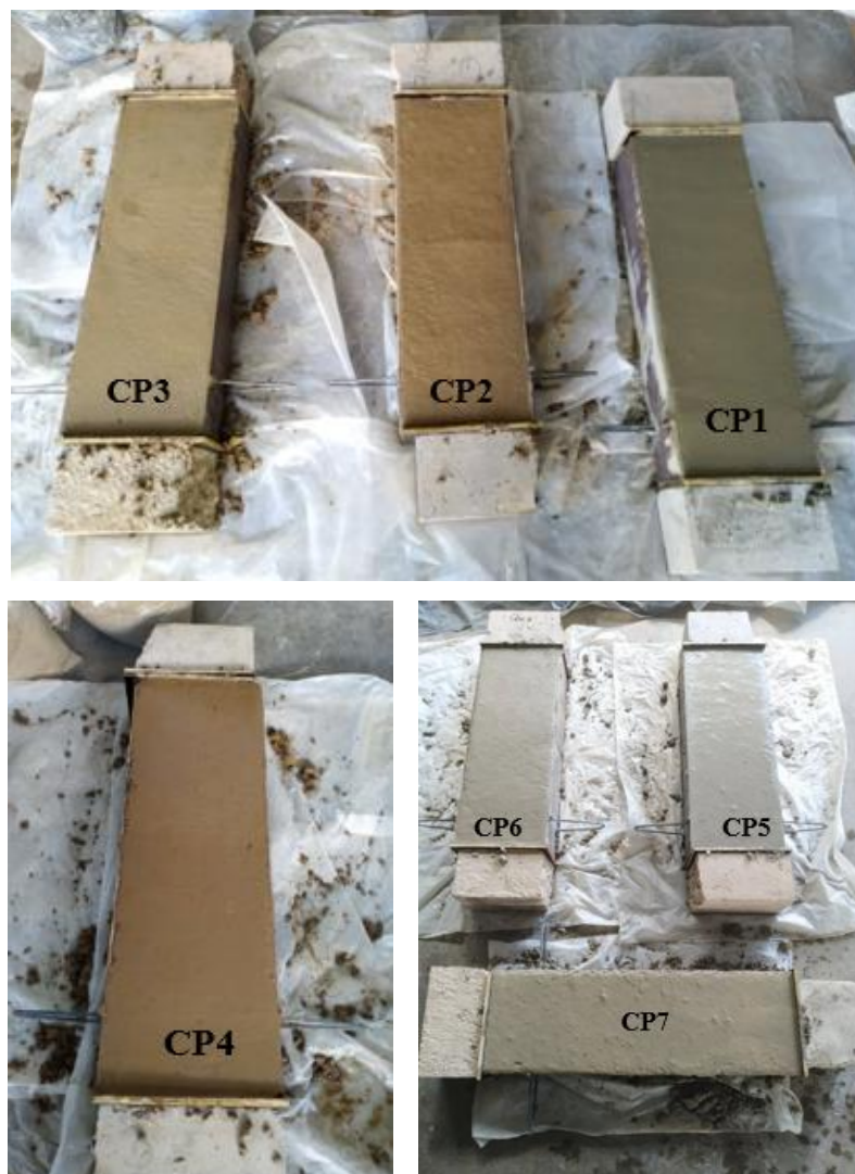
Figura 5.7 – Protótipos dos elementos mistos de aço e concreto
