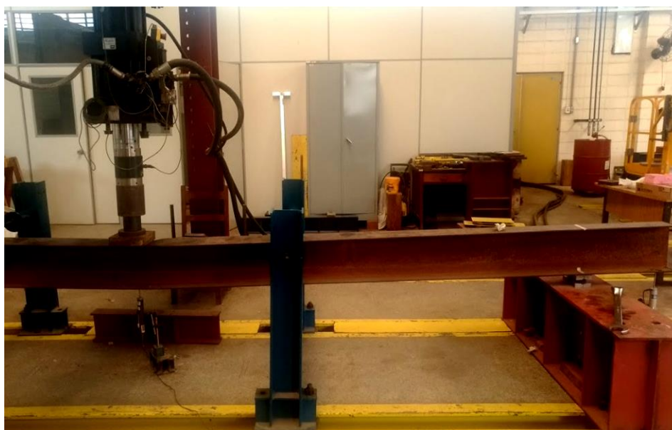
Figura 6.15 – VAço deformada com 6,4 cm de deslocamento central
