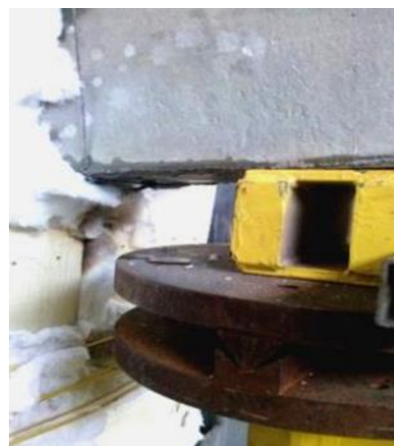
b) Viga mista de aço e concreto
