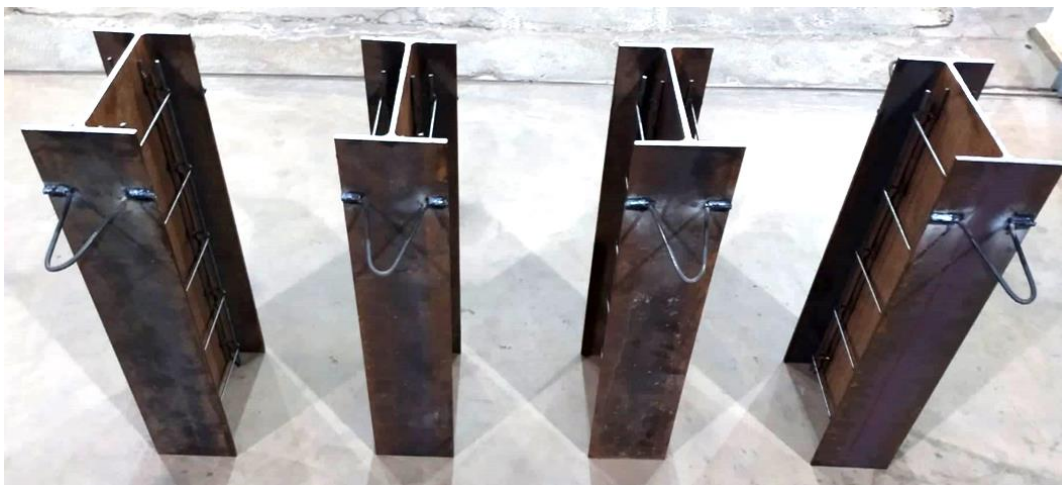
Figura 5.4 – Corpos de prova dos elementos mistos ainda não concretados
