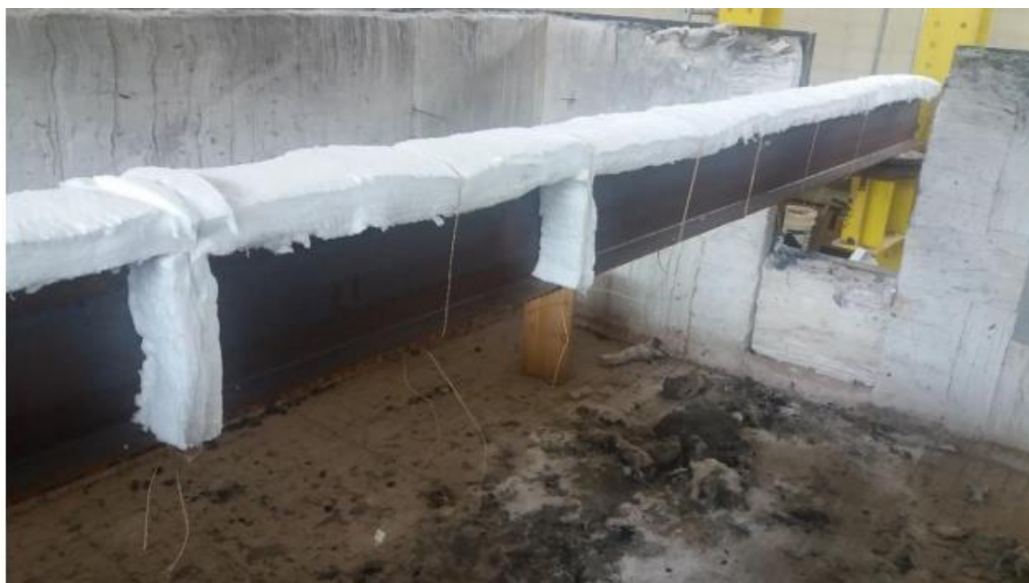
Figura 3.19 – Viga de aço inserida no forno horizontal do laboratório de estruturas do SET da EESC/USP
