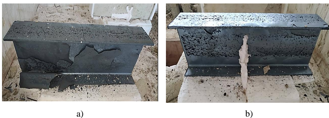
Figura 5.25 – Corpo de prova CP8 pós-fogo: a) lado 01; b) lado 02
