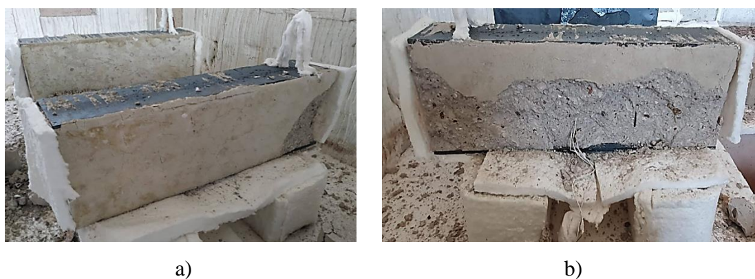
Figura 5.24 – Corpo de prova CP7 pós-fogo: a) lado 01; b) lado 02
