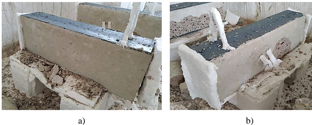
Figura 5.20 – Corpo de prova CP3 pós-fogo: a) lado 01; b) lado 02
