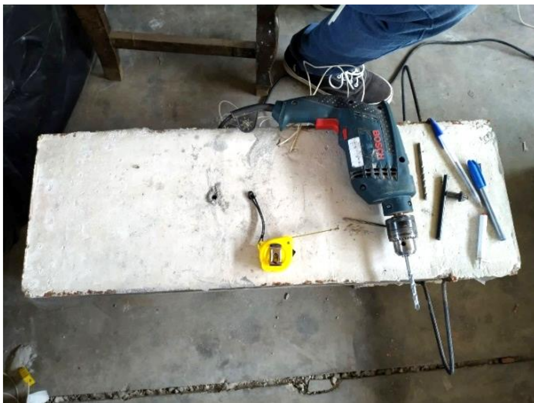
Figura 5.8 – Fixação dos termopares na região do concreto
