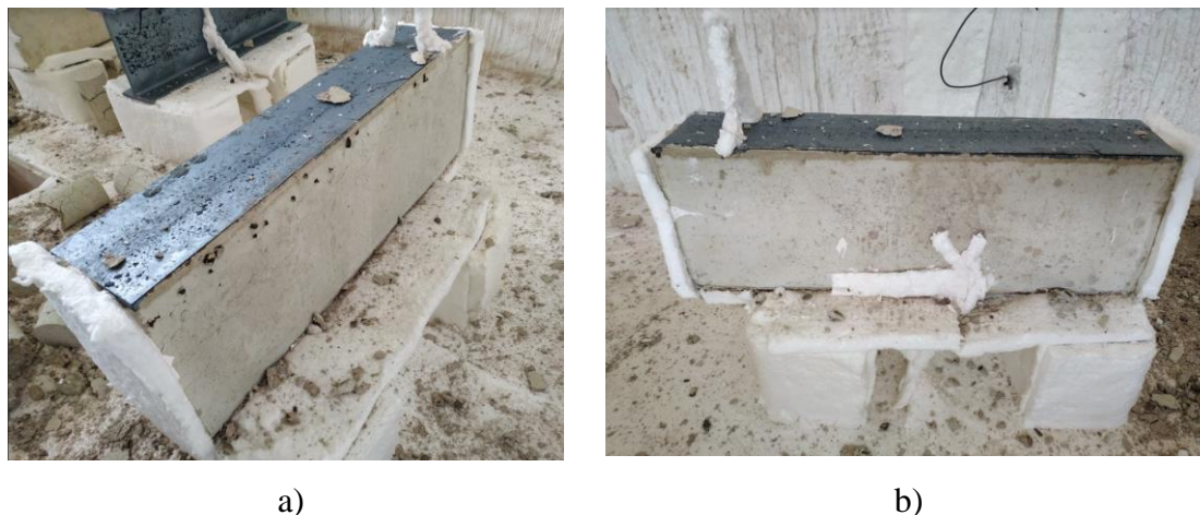
Figura 5.18 – Corpo de prova CP1 pós-fogo: a) lado 01; b) lado 02
