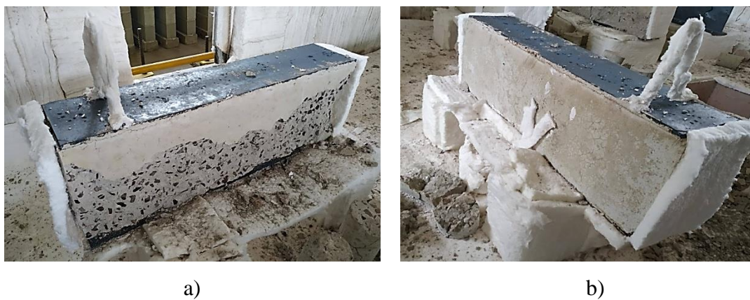
Figura 5.22 – Corpo de prova CP5 pós-fogo: a) lado 01; b) lado 02
