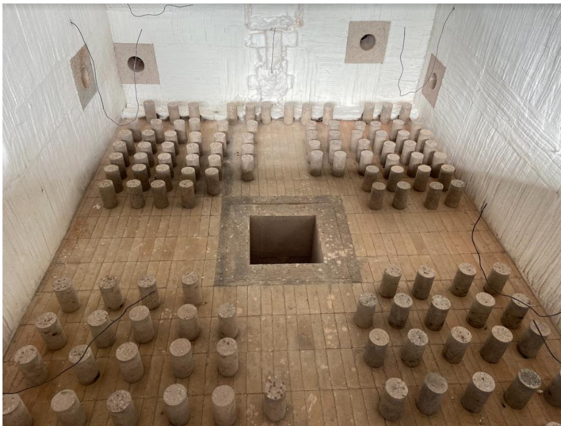
Figura 7.5 – Corpos de prova dentro do forno após incêndio
