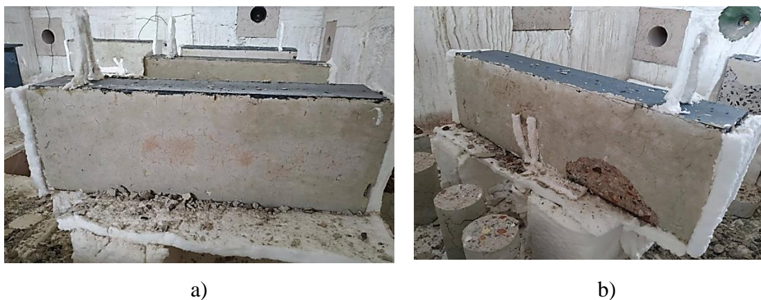
Figura 5.21 – Corpo de prova CP4 pós-fogo: a) lado 01; b) lado 02
