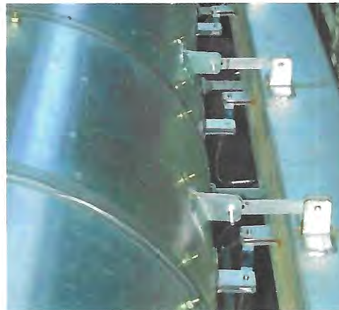
Figura 32 - Sistema de medição da força de atrito nas paredes, célula de carga de 8 kN.
