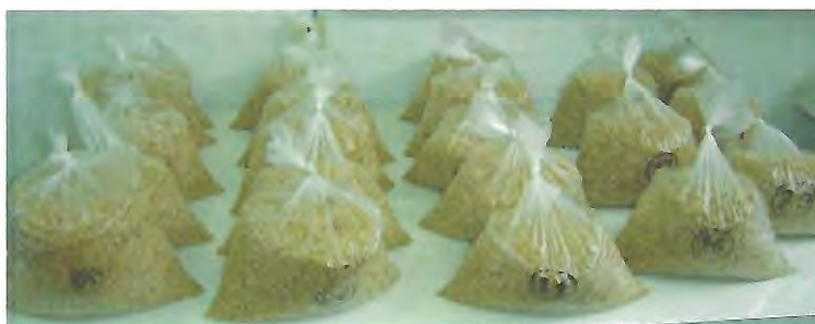
Figura 23 – Amostras de soja utilizadas no Jenike Shear Tester .
