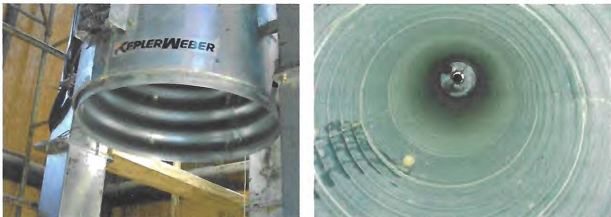
Figura 38 - Parede interna rugosa do silo piloto.
