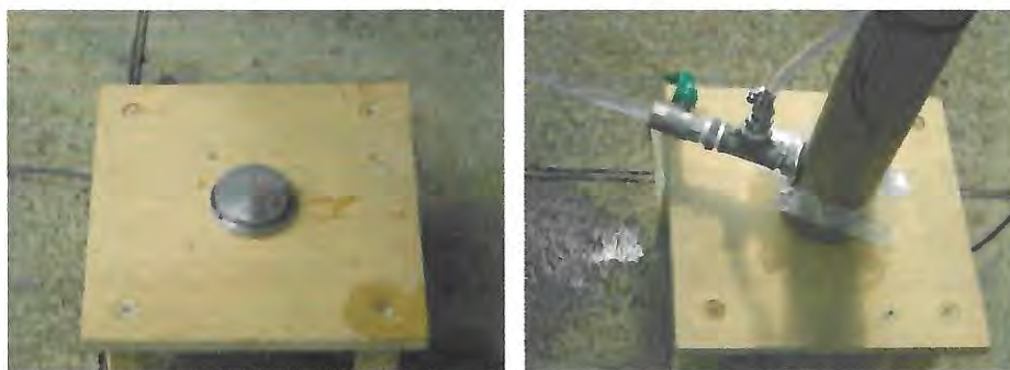
Figura 42 – Calibração da célula de pressão.
