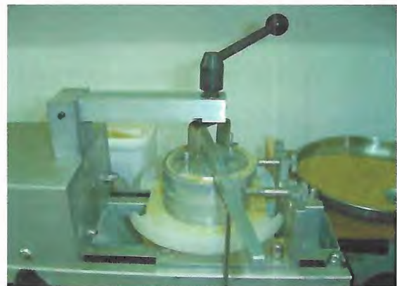
Figura 19 – Aparado de cisalhamento direto, Jenike Shear Tester .
