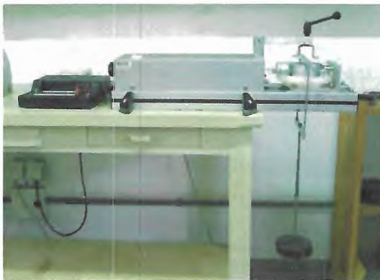
Figura 19 – Aparado de cisalhamento direto, Jenike Shear Tester .
