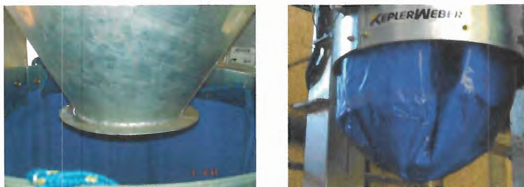
Figura 44 - Revestimento do silo piloto com lona plástica.
