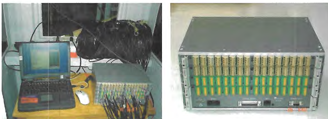
Figura 40 - Sistema de aquisição de dados utilizado no silo piloto.
