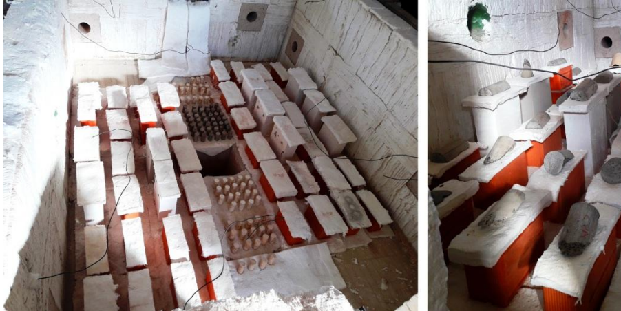
Figura 4.4 – Disposição dos corpos de prova na fornada I
