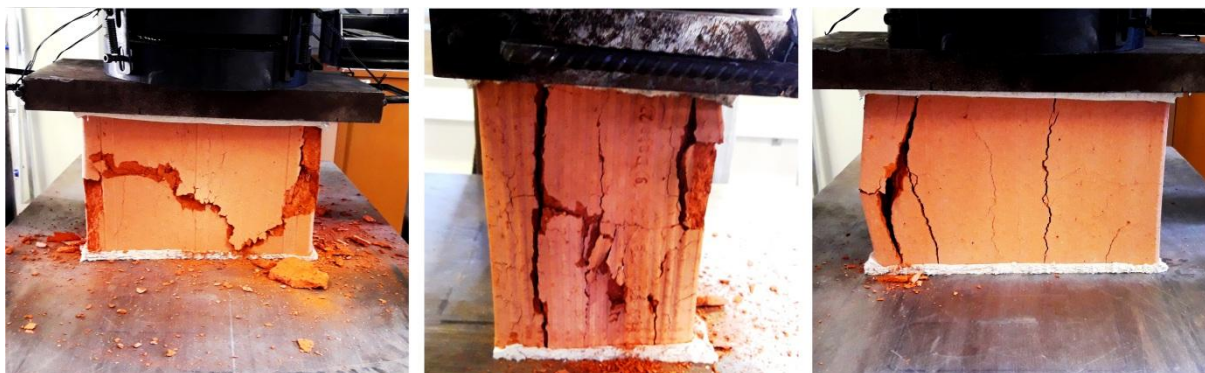
Figura 5.12 – Modo de ruptura das unidades cerâmicas após situação de incêndio
