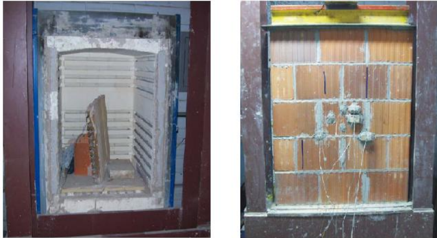
Figura 2.16 – Vista geral do forno e da pequena parede antes do ensaio
