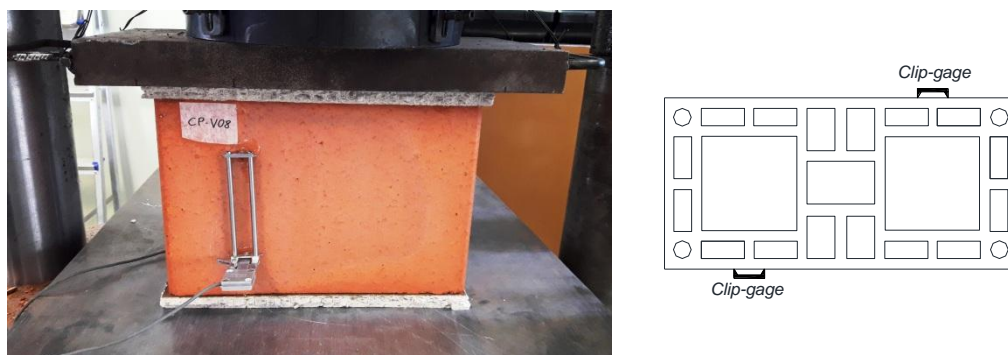
Figura 3.7 – Ensaio de resistência à compressão em bloco cerâmico
