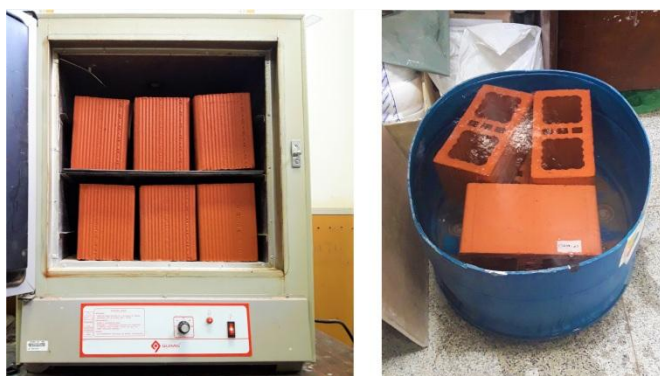
Figura 3.6 – Procedimento de secagem e saturação dos blocos cerâmicos
