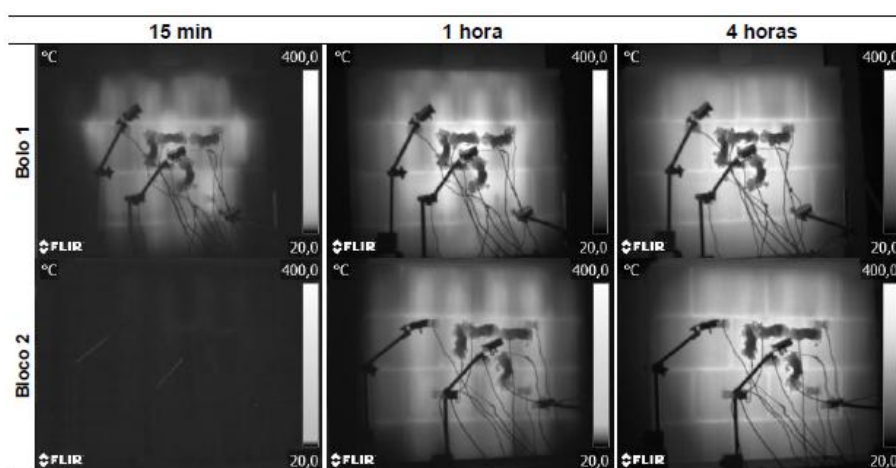
Figura 2.18 – Termografia em blocos cerâmicos estruturais com espessura de 14 cm e 19 cm
