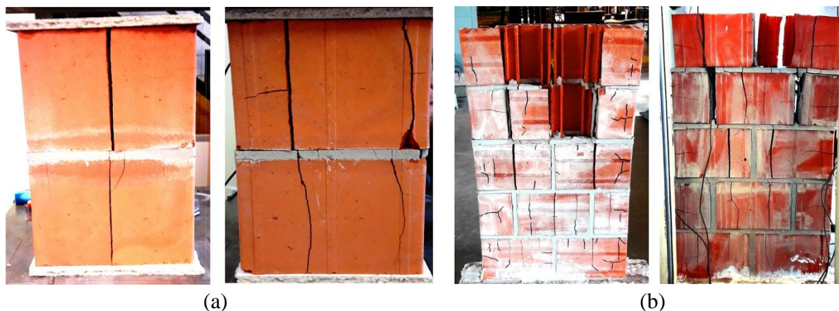
Figura 5.3 – Aspecto superficial dos (a) prismas e (b) pequenas paredes isoladas após situação de incêndio
