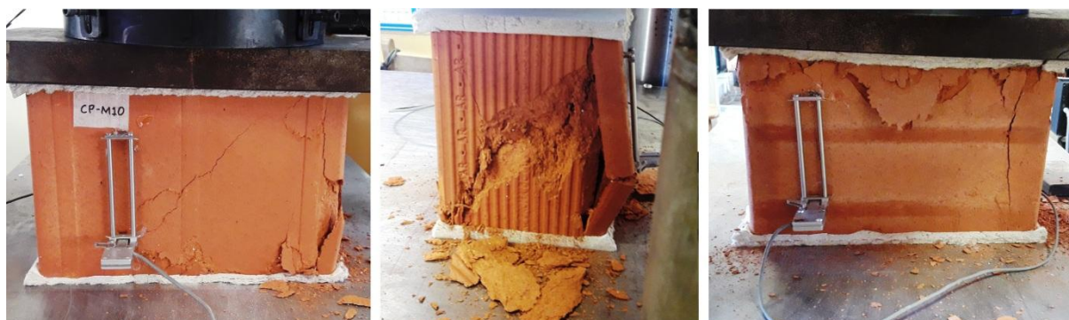
Figura 3.11 – Modo de ruptura das unidades cerâmicas
