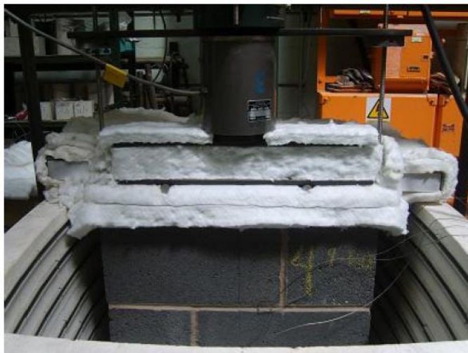
Figura 2.24 – Pequena parede de alvenaria estrutural sob teste de compressão antes da elevação de temperatura
