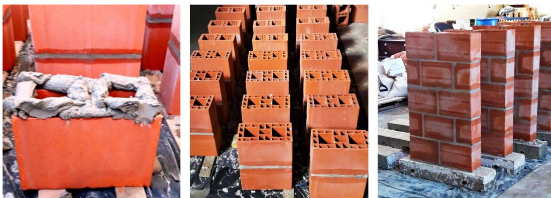
Figura 3.27 – Execução dos prismas e pequenas paredes de alvenaria estrutural
