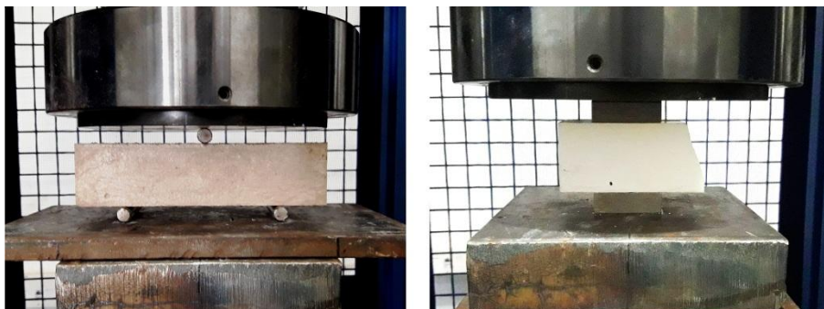
Figura 3.22 – Ensaios de flexão e compressão em argamassas para revestimento
