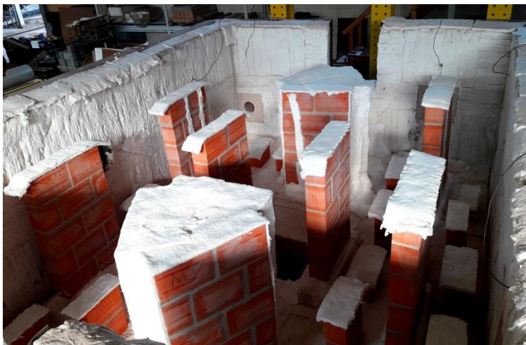
Figura 4.7 – Disposição dos corpos de prova na fornada II
