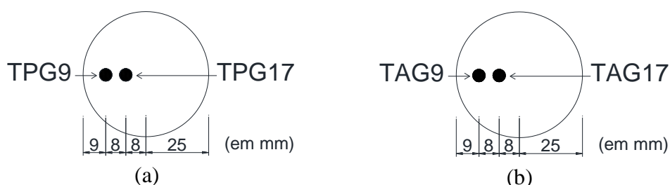
Figura 4.20 – Instrumentação dos revestimentos em gesso (a) pasta e (b) argamassa 1:2
