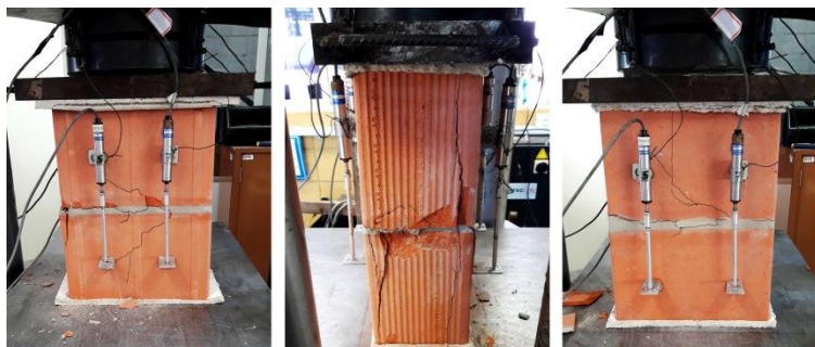
Figura 3.31 – Modo de ruptura dos prismas
