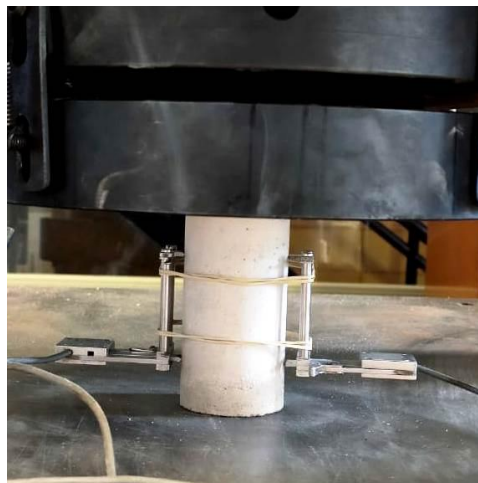
Figura 3.17 – Ensaio de resistência à compressão da argamassa de assentamento
