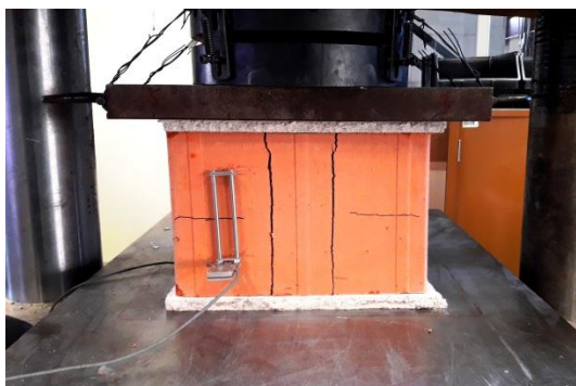
Figura 5.10 – Ensaio de resistência à compressão em bloco após situação de incêndio
