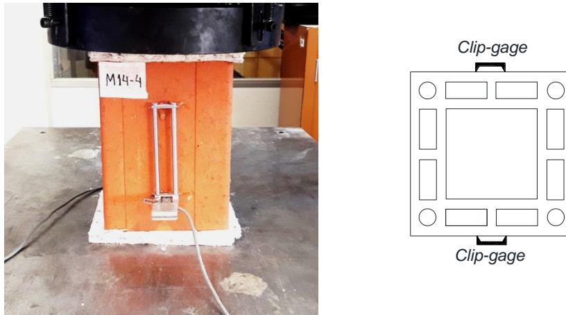
Figura 3.9 – Ensaio de resistência à compressão em meio-bloco cerâmico
