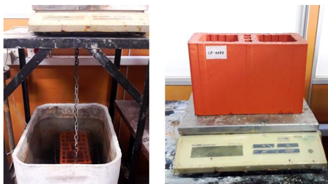
Figura 3.5 – Determinação das massas aparente e saturada das unidades cerâmicas
