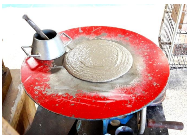
Figura 3.16 – Procedimento para obtenção do índice de consistência da argamassa
