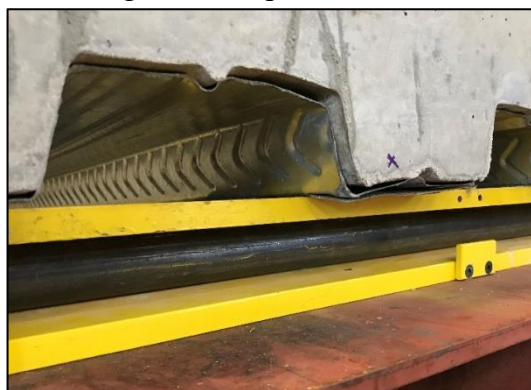
(b) Deslizamento relativo de extremidade entre o concreto e a fôrma de aço
