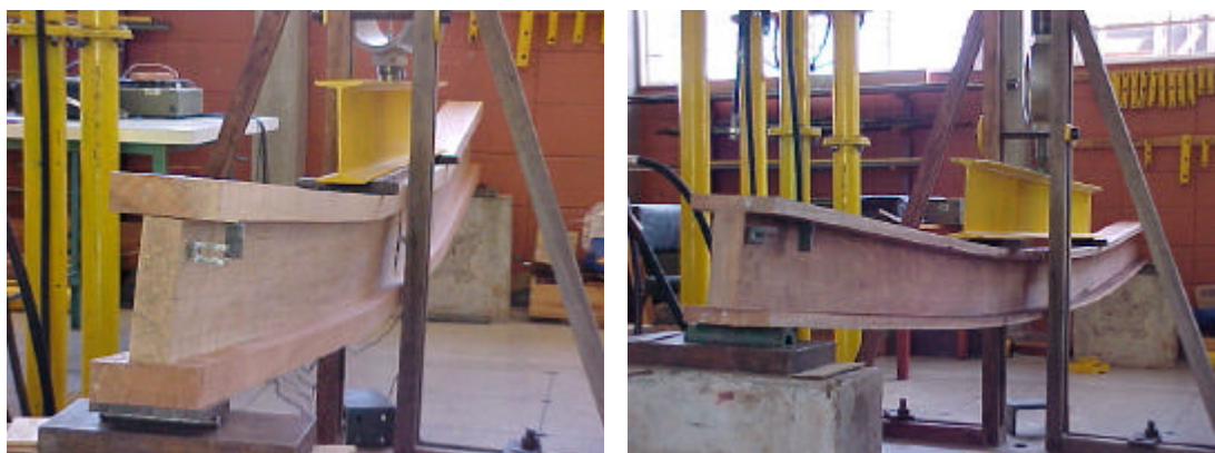
Figura 38 – Comportamento de duas vigas compostas próximo à ruptura.
