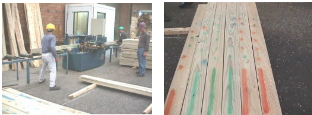
Figura 41 – Desenvolvimento da classificação com a máquina MSR
