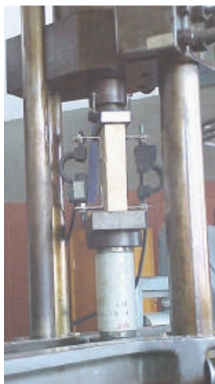
Figura 46 – Transdutores de deslocamento e célula de carga.
