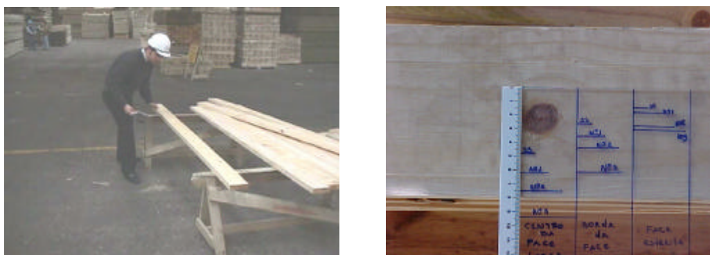
Figura 38 – Classificação visual e detalhe do gabarito de acrílico.
