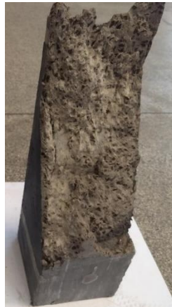
(b) Ruptura no UHPC
