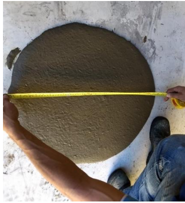
Figura 3.1.5 - Medição do espalhamento do UHPC
