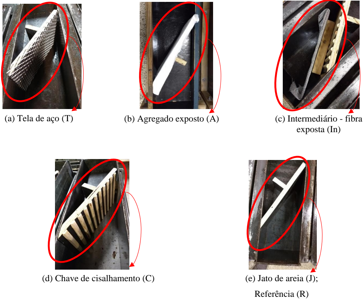
Figura 3.7.4 - Detalhe dos moldes na divisória para confecção das interfaces
