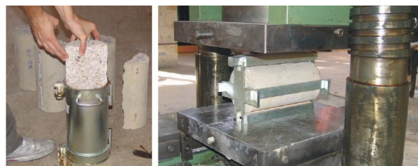
Figura 2.17 - Metade do corpo de prova do concreto velho no molde cilindro e configuração do ensaio de resistência à tração por compressão diametral (Fonte: ESPECHE; LEÓN, 2010)
