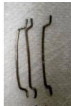
Figura 3.1.6 - Fibras ancoradas usadas no concreto intermediário
