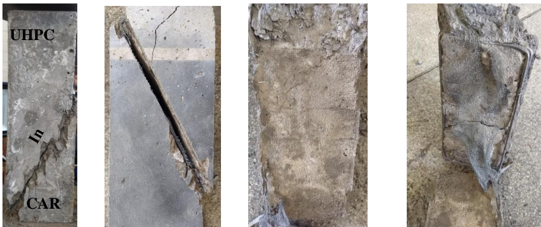
Figura 4.5.10- Imagem típica do corpo de prova após ruptura na interface Intermediária - fibra (In)
