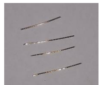
Figura 3.1.3 - Fibras retas usadas no UHPC
