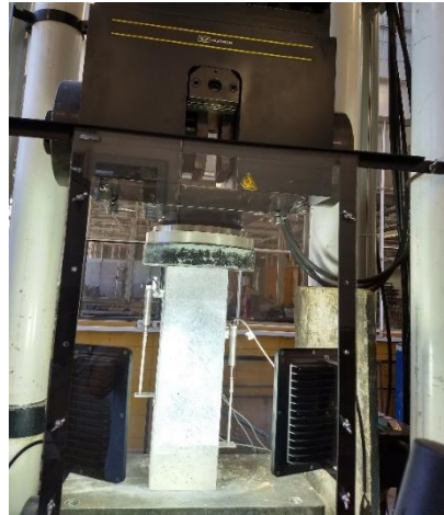
Figura 3.7.10 - Aparato montado para análise de imagem
