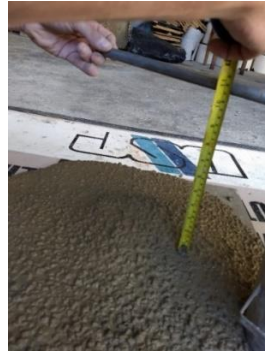
Figura 3.1.2 - Medição do abatimento do CAR
