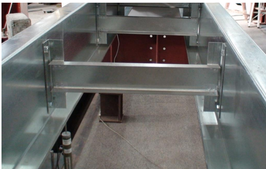
Figura 3.5 – Dispositivos de travamento lateral entre linhas de terças.
