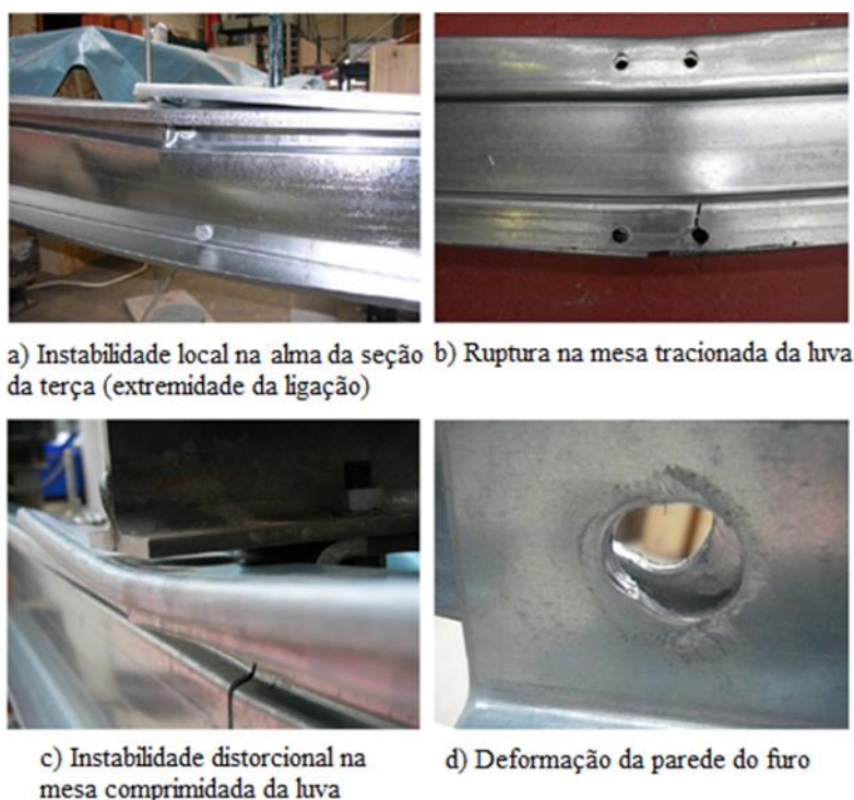
Figura 2.17 – Modos de falha da ligação.
