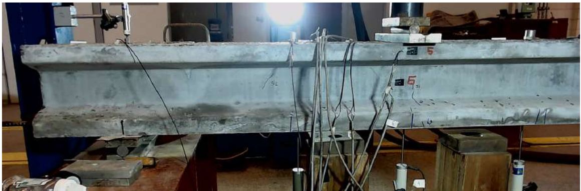
Figura 7.14: Fissuração da viga UHPC-P-Flex-Cis antes da ruptura
