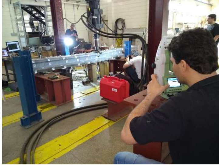
Figura 5.26: Ensaios de monitoramento geodésico
