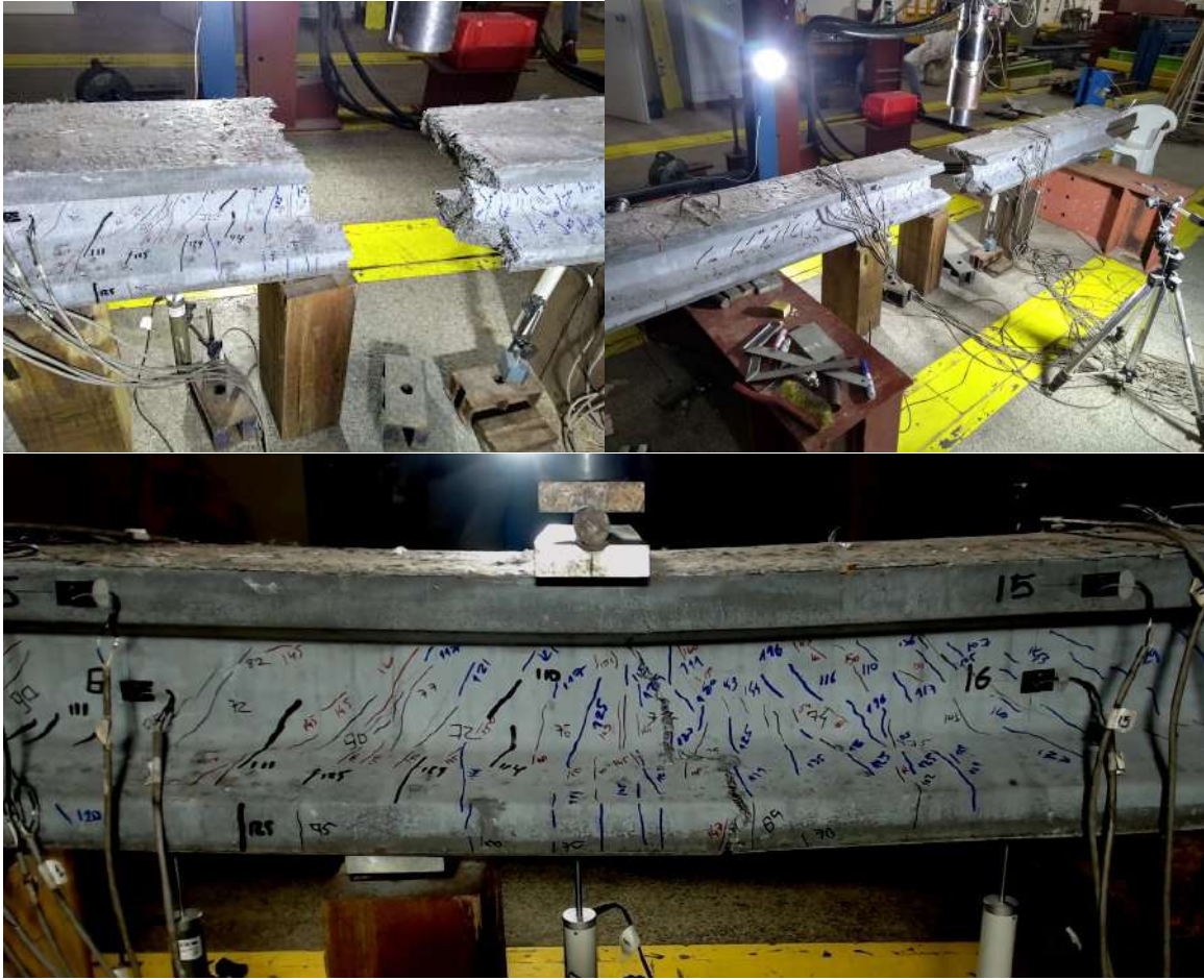
Figura 7.6: Ruptura da viga UHPFRC sem protensão (V03)
