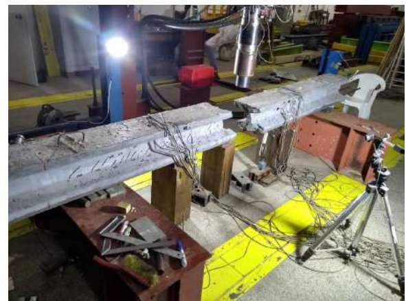
(b) Após a ruptura das armaduras
