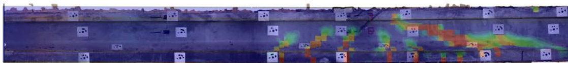
(a) Comparação modelo numérico e ortofoto experimental - V05 - UHPC - P - Flex - Cis
