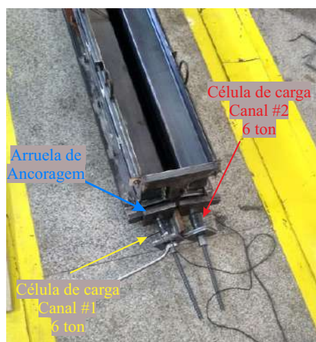
(b) Ancoragem e célula de carga
