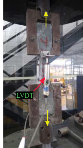
(b) Configuração de ensaio de tração uniaxial
