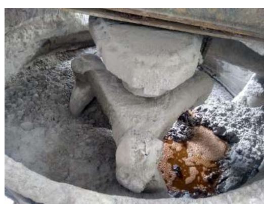
(c) Momento de adição do superplastificante na mistura de UHPC
