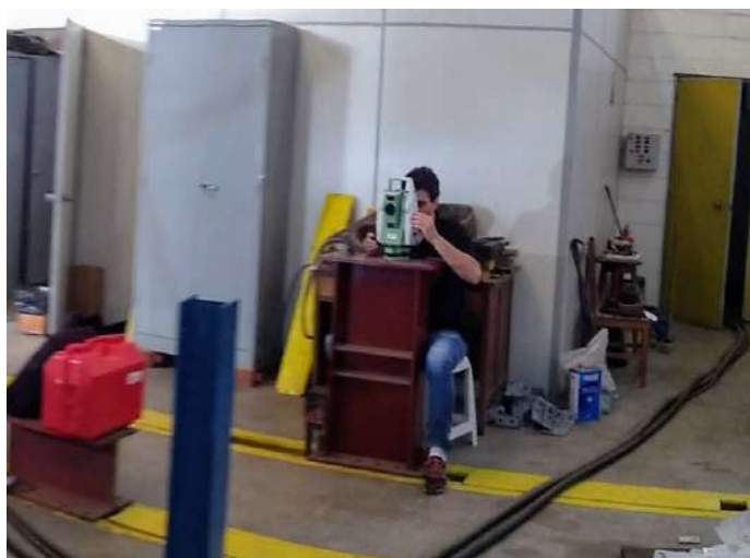
Figura 5.29: Perfil de base utilizado para fixação da RTS
