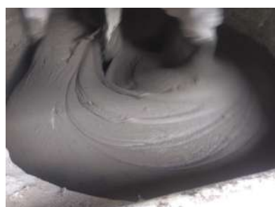
(d) Mistura homogênea de UHPC, após adição de superplastificante
