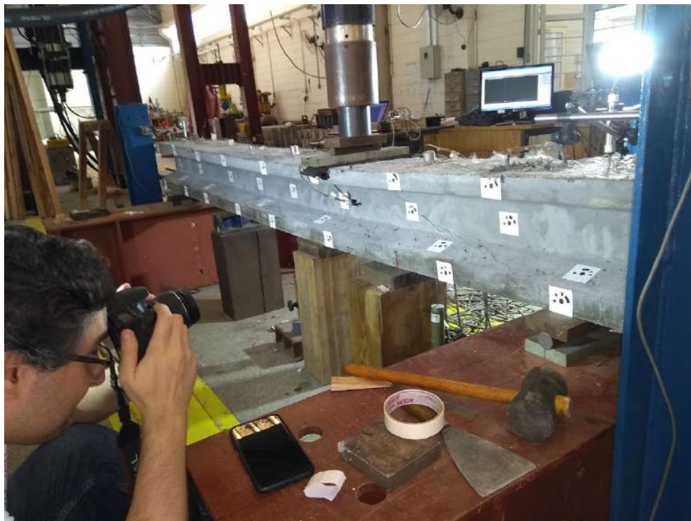
Figura 5.32: Obtenção das imagens de fotogrametria (Viga UHPFRC-P-Flex-Cis)
