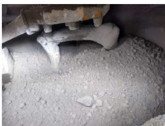
(b) Mistura de UHPC sem o superplastificante
