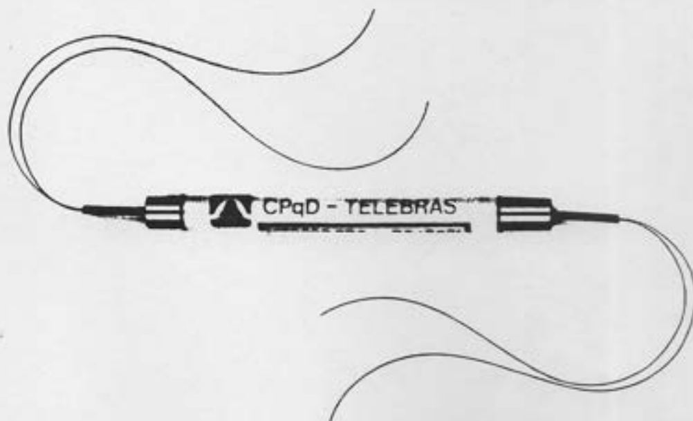
Fig.3.4. - Foto ilustrando o encapsulamento primário de um acoplador óptico FEB do CPqD-TELEBRÁS.
