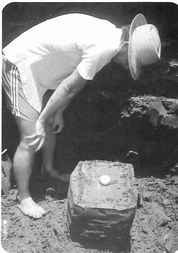
*Foto 5.2. Coleta de amostra indeformada de Solo no depósito aluvial pré-atual - Margem do Córrego do Veado - Amostra A 5/3 referida na tabela 5.9.*
