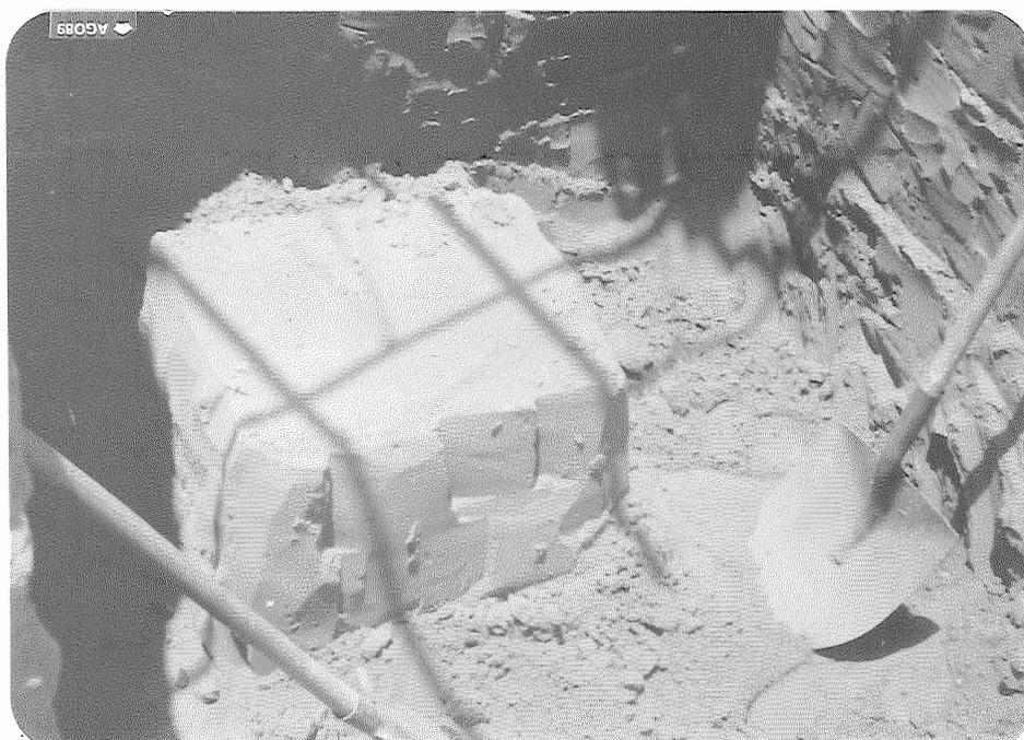
Foto 5.1. Coleta de amostra indeformada de Solo no depósito coluvial cenozóico - Amostra A 4/1 referida na tabela 5.9.
