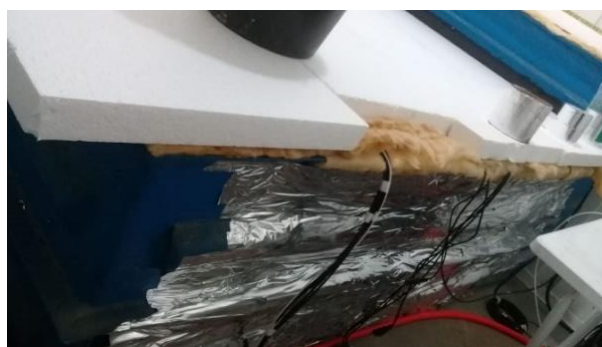
Figura 3.55: Reforço no isolamento térmico do experimento.
