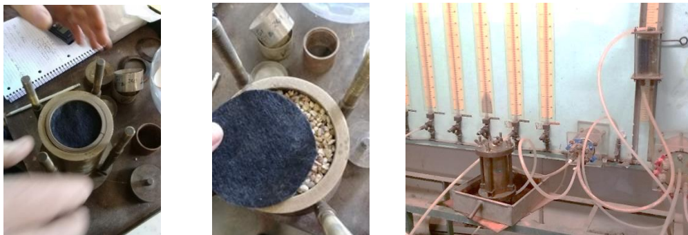
Figura 3.38: Ensaio de permeabilidade de carga constante.
