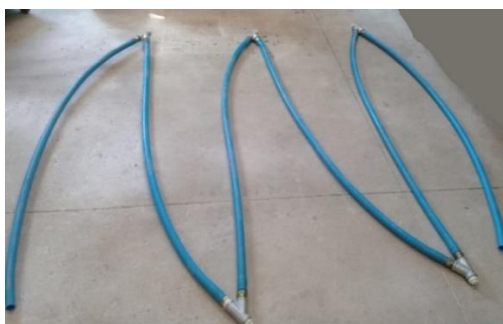
Figura 3.17: Montagem dos tubos em triplo U (em laboratório).
