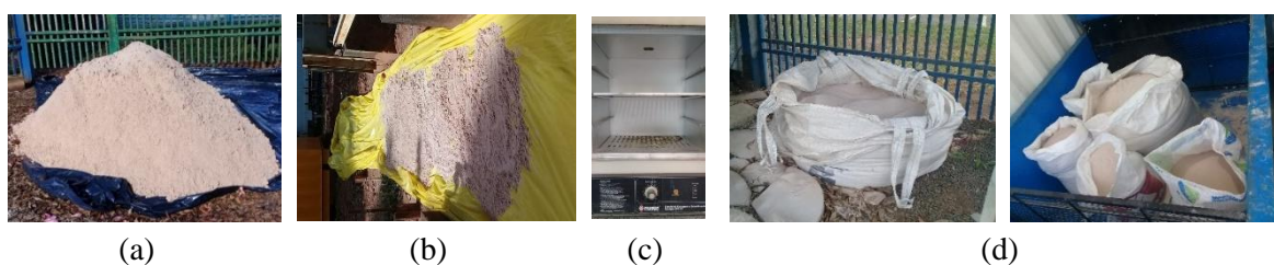
Figura 3.43: Areia de Analândia: (a) areia úmida, (b) secagem ao ar, (c) estufa geotécnica utilizada, e (d) areia seca armazenada em bags.
