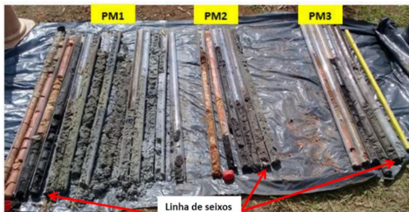
Figura 3.6: Liners coletados durante a amostragem para instalação dos poços PM-1, PM-2 e PM-3.
