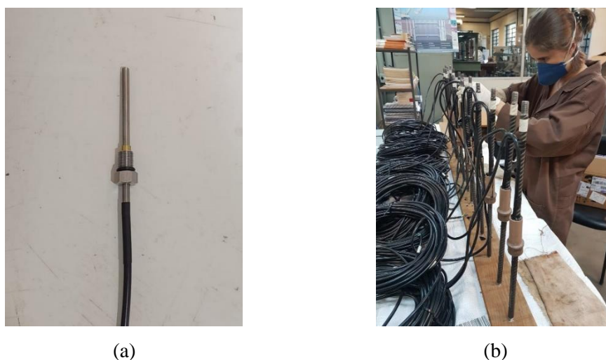
Figura 3.20: Sensores utilizados para medir cargas térmicas e mecânicas: (a) Pt-100 e (b) barras instrumentadas com strain gages .
