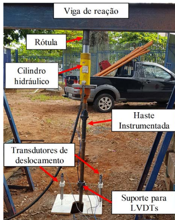
Figura 32 - Componentes envolvidos no ensaio estático.
