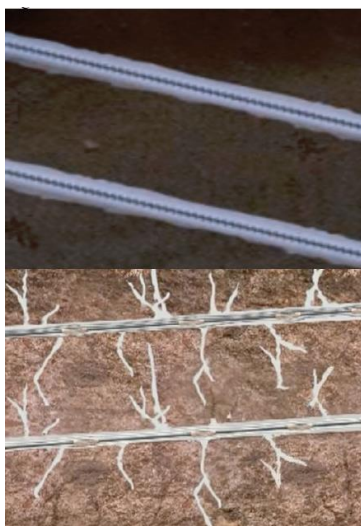
Figura 21 - Grampos não injetados acima e grampos injetados abaixo (Pitta, Barbosa e Assis, 2017)
