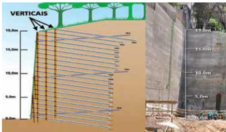
Figura 16 - Utilização de grampos verticais (Pitta, Souza e Zirlis, 2013)
