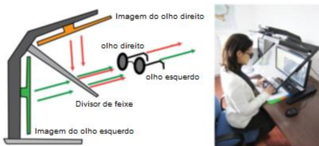
Figura 6 – Tecnologia da Planar StereoMirror™ para obtenção de imagem em 3D.
