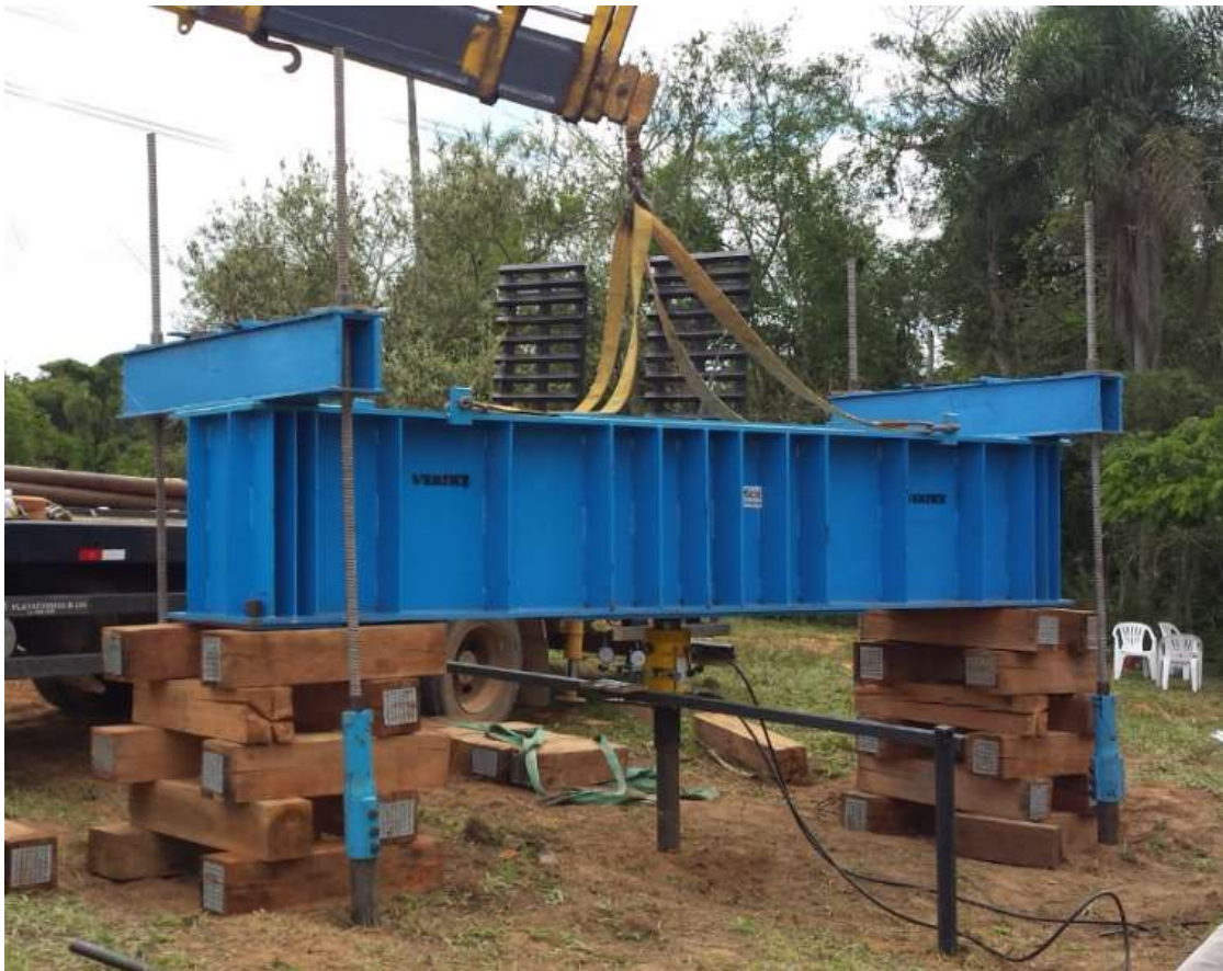
Figura 4.14: Sistema de reação utilizado nas provas de carga à compressão.
