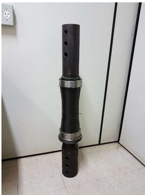
Figura 4.10: Obturador inflável montado em extensão de estaca helicoidal.
