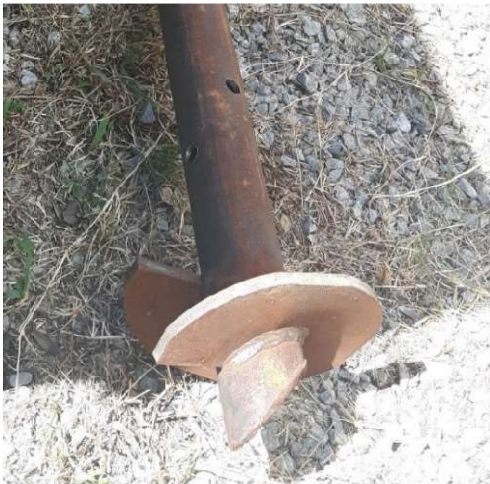
Figura 4.6: Detalhe da furação para saída da calda.
