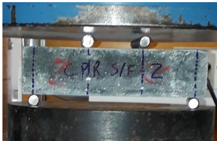
Figura 4.26 – Prisma de CPR S/F posicionado na prensa elétrica hidráulica.
