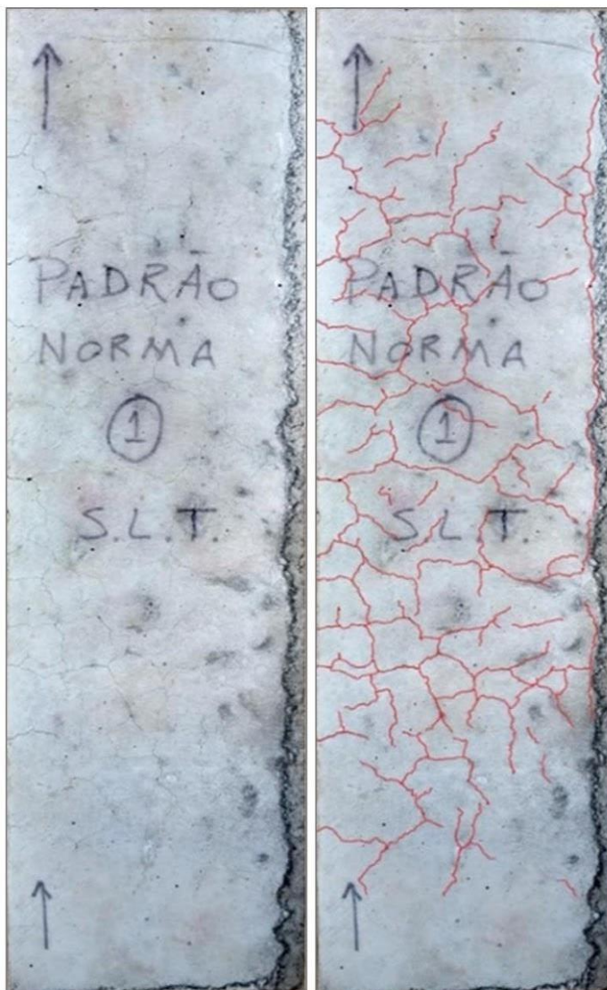
Figura 3.35 - Fissuras generalizadas nas superfícies da amostra STL0 (padrão) destacadas na cor vermelha.
