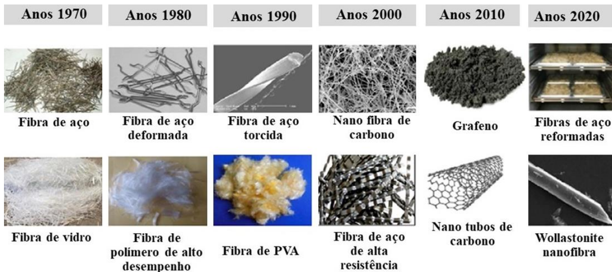
Figura 4.6 - Evolução da utilização de materiais de reforço em CUADs nas últimas 5 décadas.
