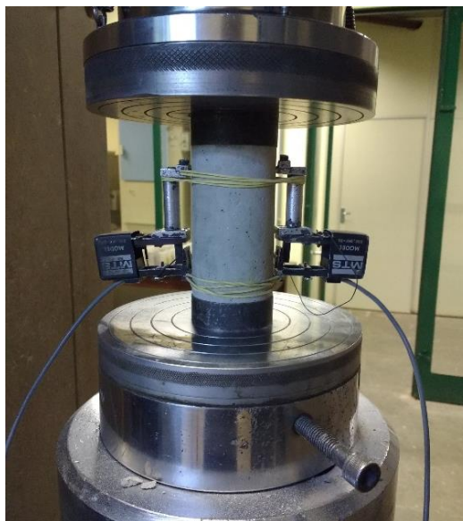
Figura 4.27 - Instrumentação dos corpos de prova de CPR's para determinação dos módulos de elasticidade.
