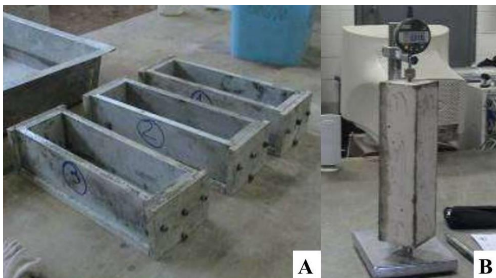
Figura 3.20 – (A) Moldes para produção dos prismas de concreto; (B) Aparato para medição da expansão
