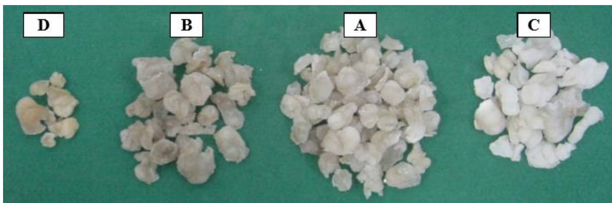
Figura 3.8 - Géis coletados na superfície do concreto afetado pela RAS na UHE-FURNAS.
