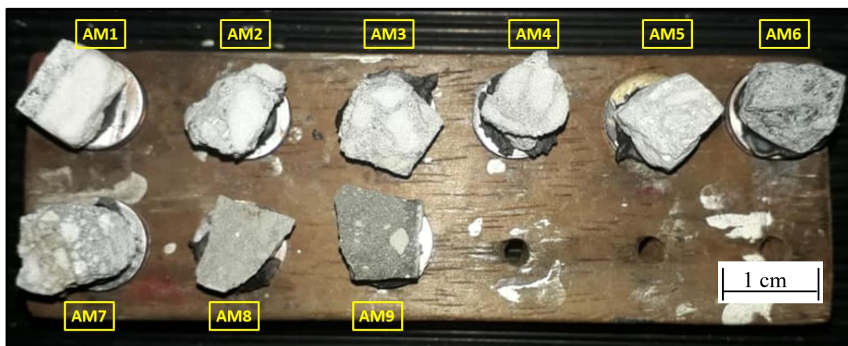
Figura 3.30 – Amostras de fragmentos de argamassas, concretos e CPRs fixadas no porta alumínio para realização da MEV.
