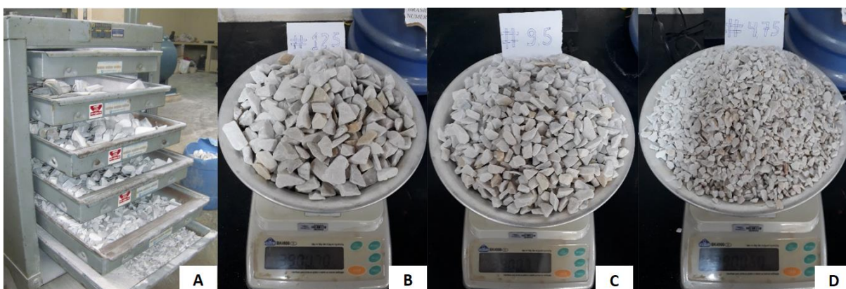
Figura 2.12 – Preparação da fração graúda da amostra ALP 2.
