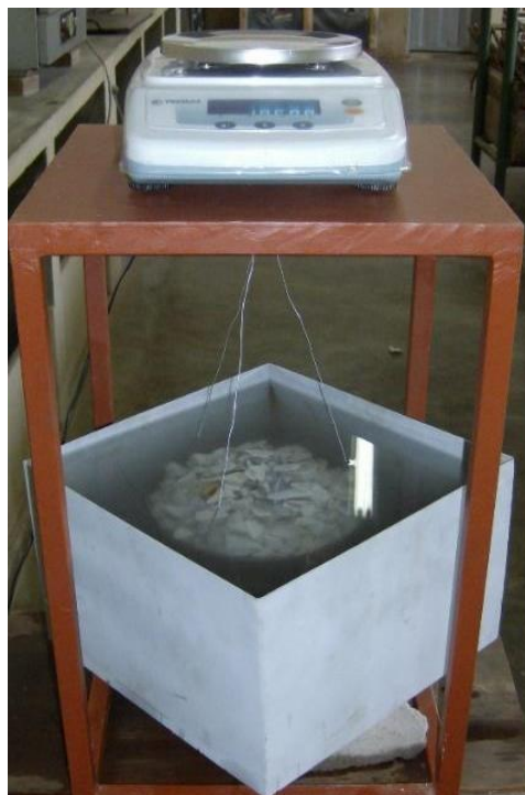
Figura 2.13 - Balança hidrostática utilizada para determinação dos índices físicos dos agregados
