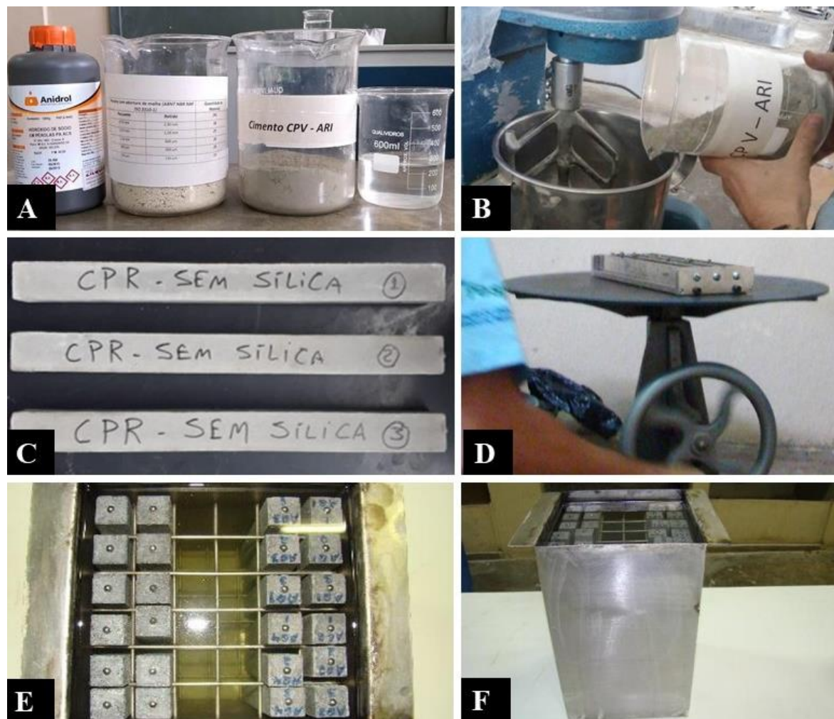
Figura 3.26 - (A) materiais utilizados para a produção das barras de argamassa; (B) adição de material na argamassadeira; (C) barras de CPRs confeccionadas; (D) processo de adensamento utilizando a mesa flow; (E) barras dispostas verticalmente em solução de NaOH; (F) recipiente projetado para acondicionamento das amostras
