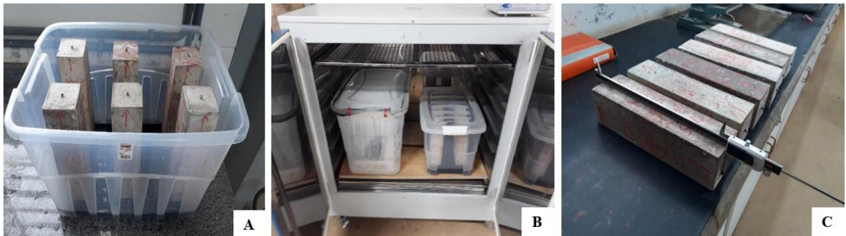
Figura 3.28 - Prismas posicionados na vertical no interior do recipiente (A); Recipientes acondicionados no interior da estufa à (60\pm 2)^\circ\text{C} (B); Medidas de comprimento com auxílio de paquímetro (C)
