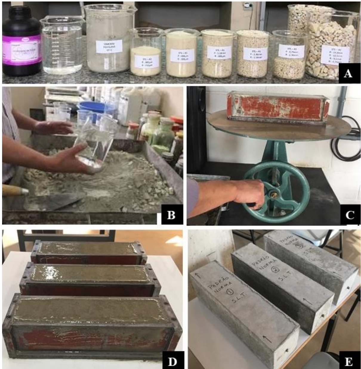
Figura 3.27 – (A) materiais utilizados para confecção dos prismas; (B) mistura manual dos materiais; (C) adensamento com auxílio da mesa flow ; (D) aspecto final dos concretos após moldagem; (E) aspecto final dos prismas de concreto após a desmoldagem.
