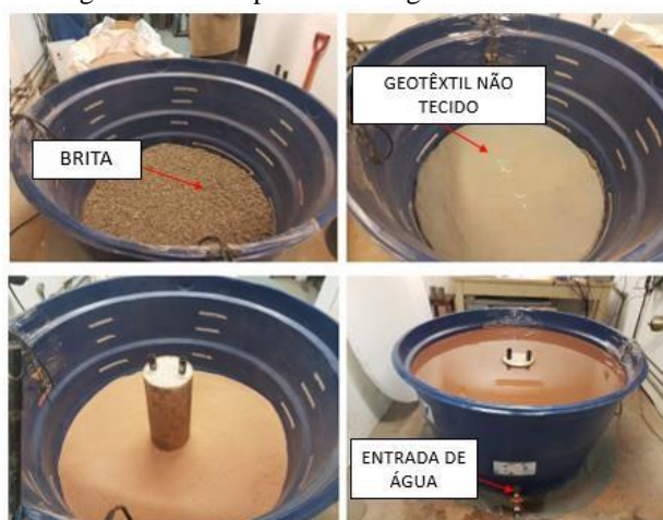
Figura 3. 16- Etapas de montagem do ensaio em areia saturada
