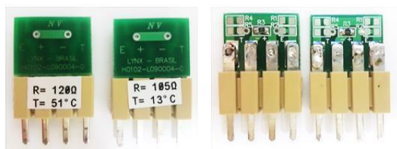
Figura 3. 18- Resistências usadas para calibração do PT100
