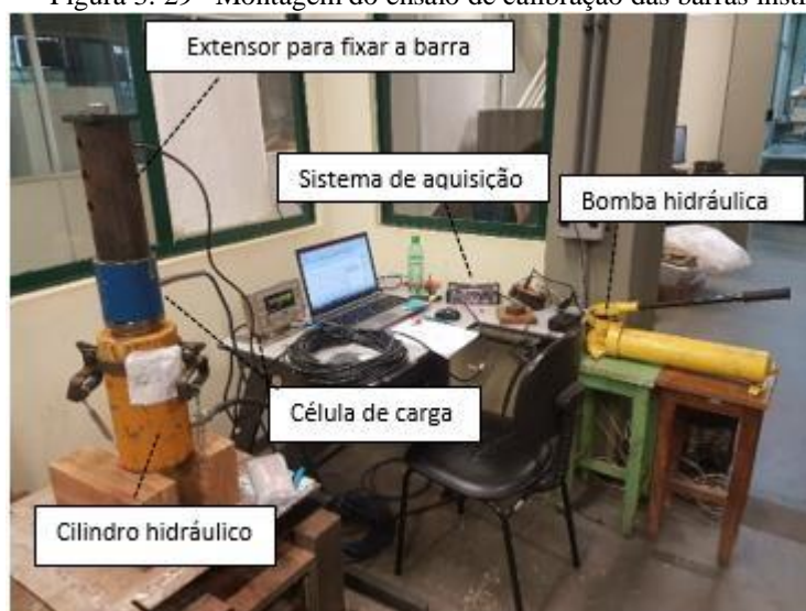
Figura 3. 29– Montagem do ensaio de calibração das barras instrumentadas
