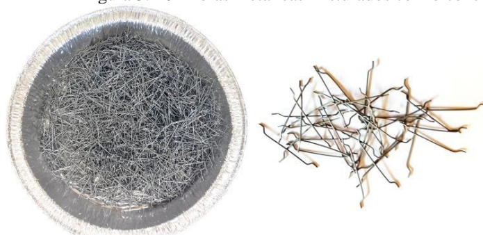
Figura 3. 10- Fibras metálicas misturados com o concreto
