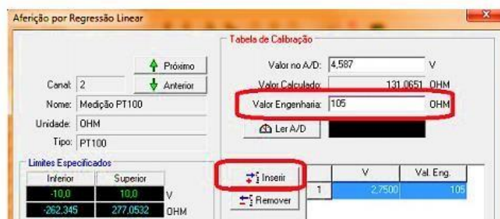
Figura 3. 19- Tela do Aqdados para calibração por regressão linear
