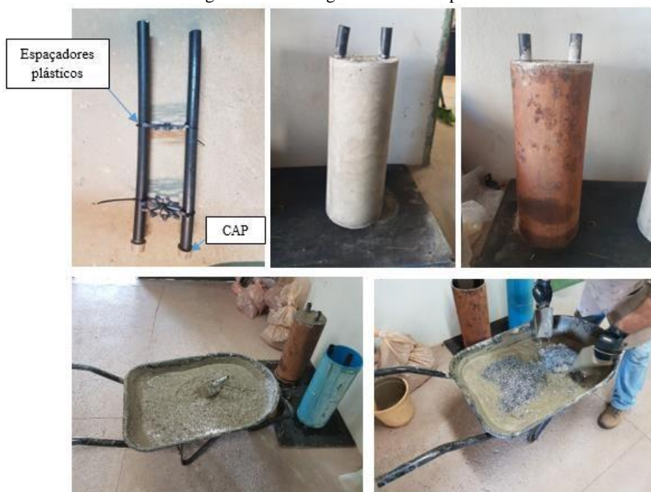
Figura 3.9- Montagem das estacas para os modelos físicos
