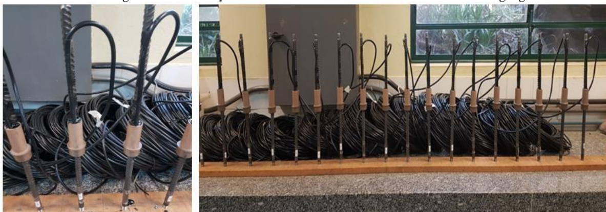
Figura 3. 30– Proteção mecânica das barras instrumentadas com strain gauges
