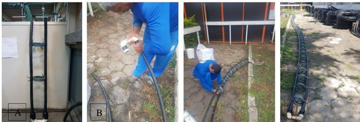
Figura 3. 25–Protótipo da estaca trocadora de calor A –em laboratório e B- em campo
