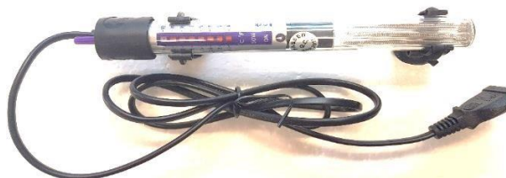
Figura 3. 14– Aquecedor com termostato utilizado no ensaio
