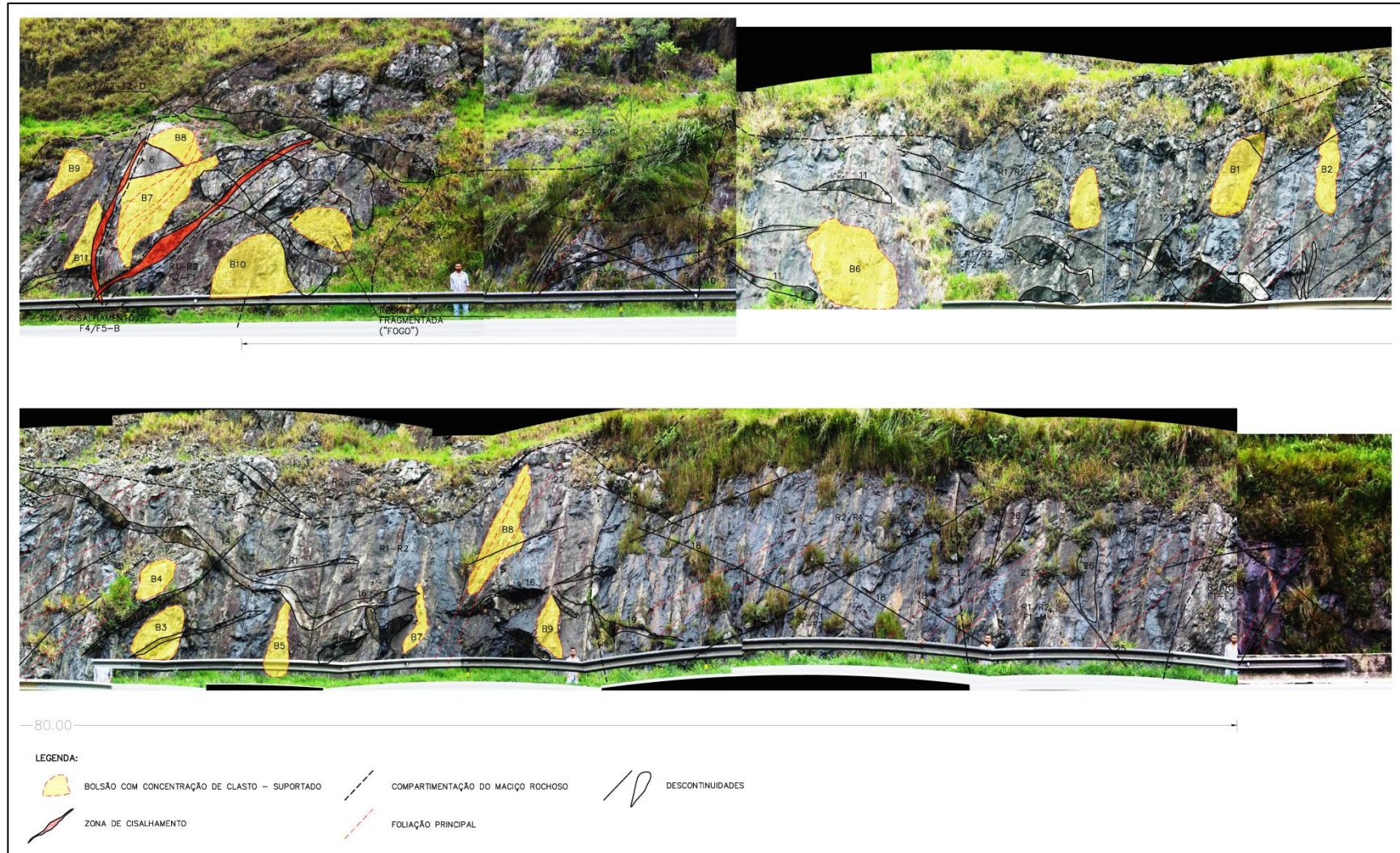
Figura 4.1 - Mapeamento geológico-geotécnico e estrutural – Rodoanel, km 9.5, São Paulo.
