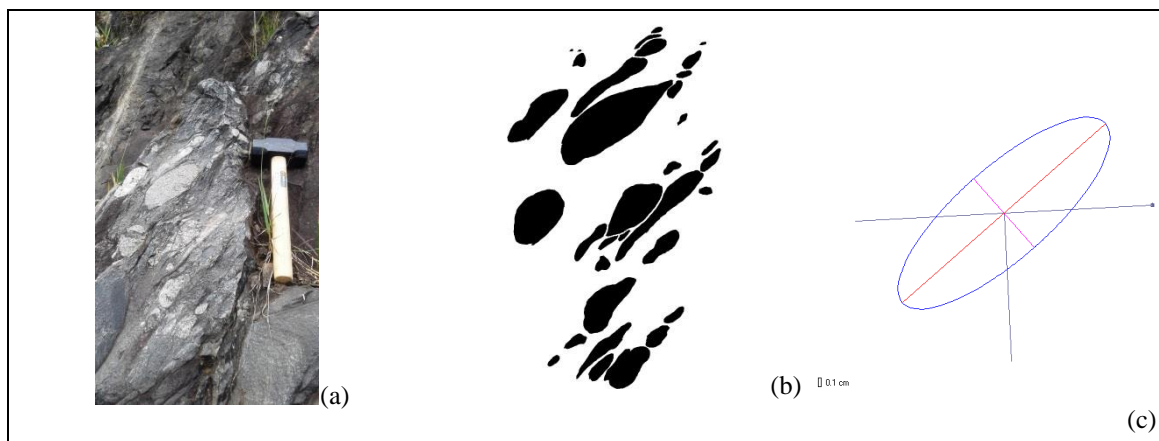
Figura 4.19 - Plano de referência 9. (a) imagem do plano de referência; (b) clastos extraídos da imagem; (c) elipse média de deformação.
