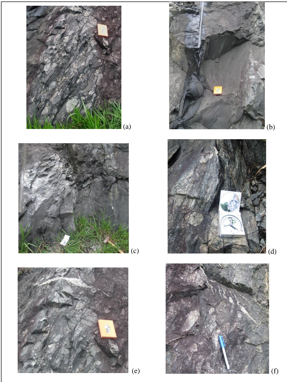
Figura 4.3 - Caracterização geológico-estrutural do metaconglomerado (a) bolsão de metaconglomerado clasto-suportado, (b) detalhe da matriz maciça; (c) feições de desmonte a “fogo”; (d) foliação penetrativa do tipo S-C na matriz e intraclasto; (e) detalhe da matriz foliada contornando os clastos e veios de quartzo truncando os clastos e a matriz; (f) feições do tipo tension gashes .
