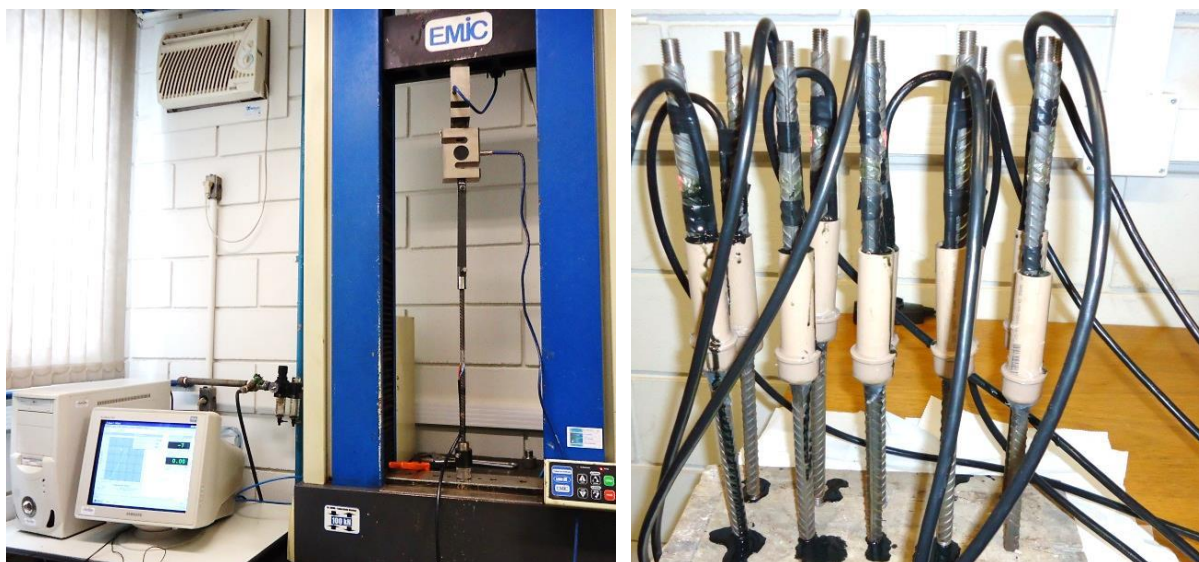
Figura 3.13: Calibração, impermeabilização e proteção mecânica das barras instrumentadas.
