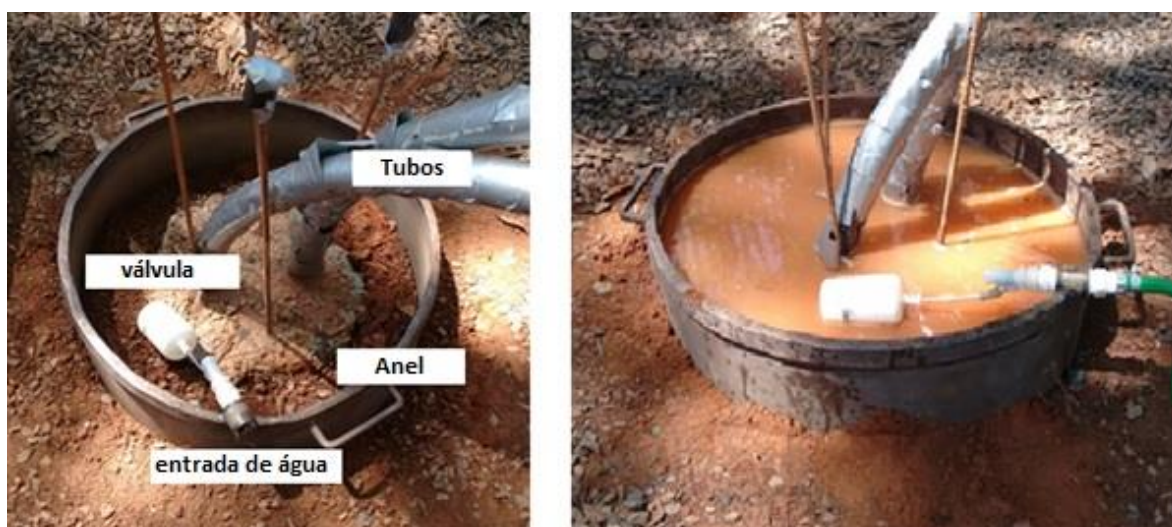
Figura 4.22: Sistema de imposição de umedecimento utilizado por Bandeira Neto (2015) no ensaio TRT04*.
