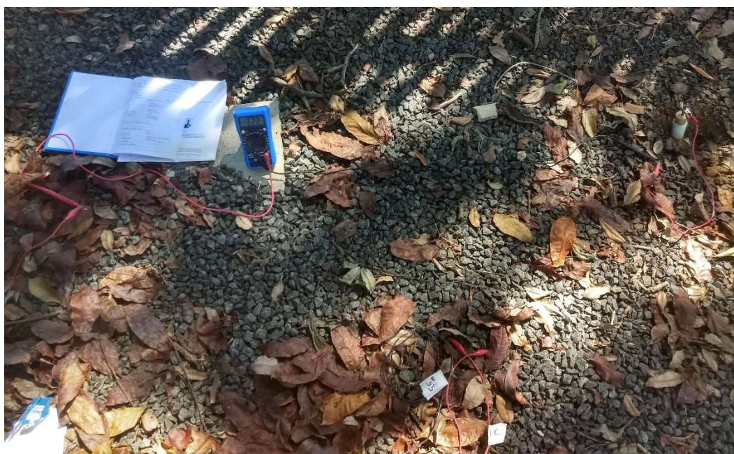
Figura 50 – Medição do Potencial de Corrosão em Campo
