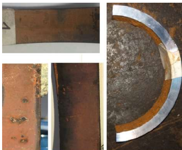
Figura 57 – Corrosão densa e coloração parecida com a da pátina na face interna de amostras
