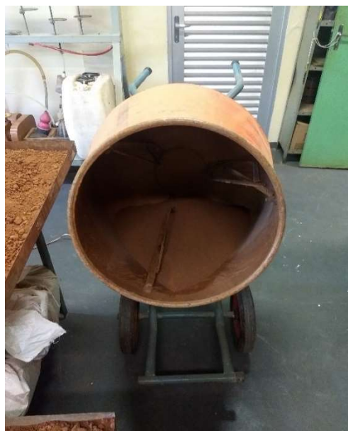
Figura 52 – Betoneira homogeneizando o solo
