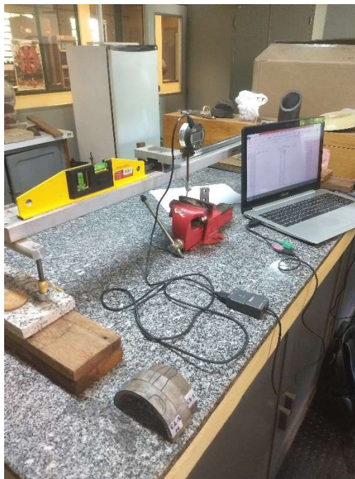
Figura 28 – Rugosímetro nivelado durante ensaio de amostra
