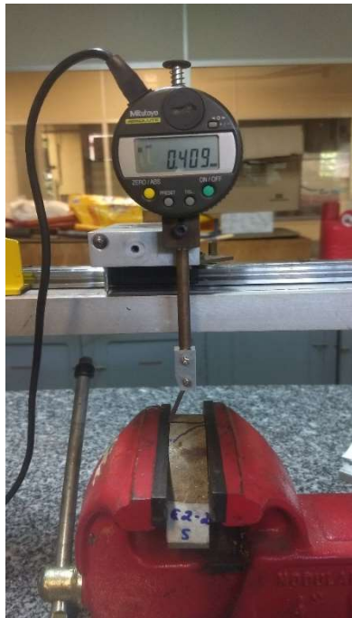
Figura 29 – Medição com deflectômetro
