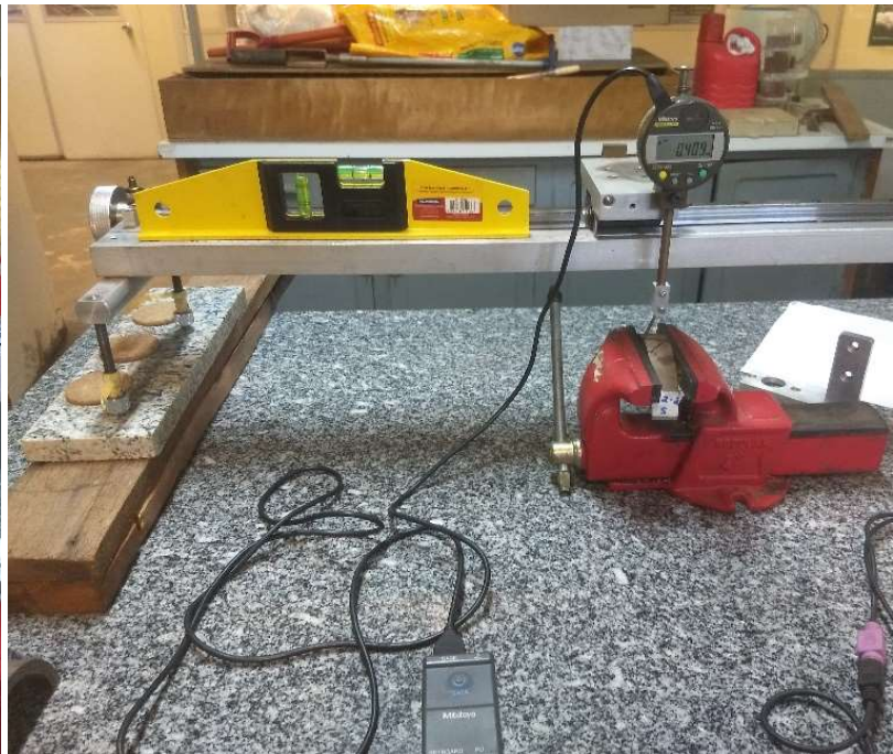
Figura 30 – Esquema de medição da rugosidade
