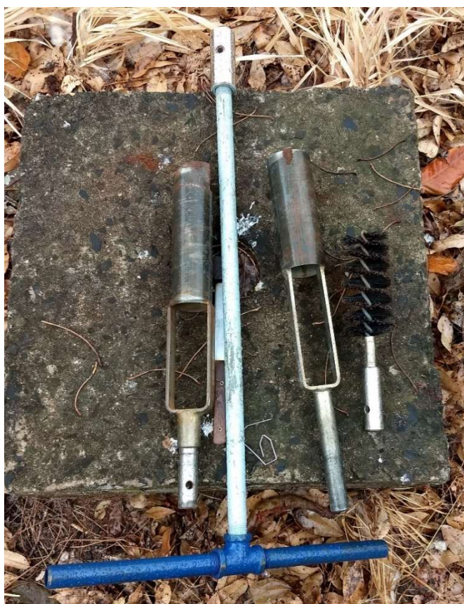
Figura 33 – Ferramentas utilizadas na abertura do furo de ensaio. Em sequência, trado, haste, nivelador e escova
