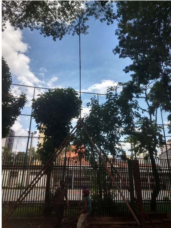
Figura 32 – Operários inserindo o amostrador com as hastes no furo
