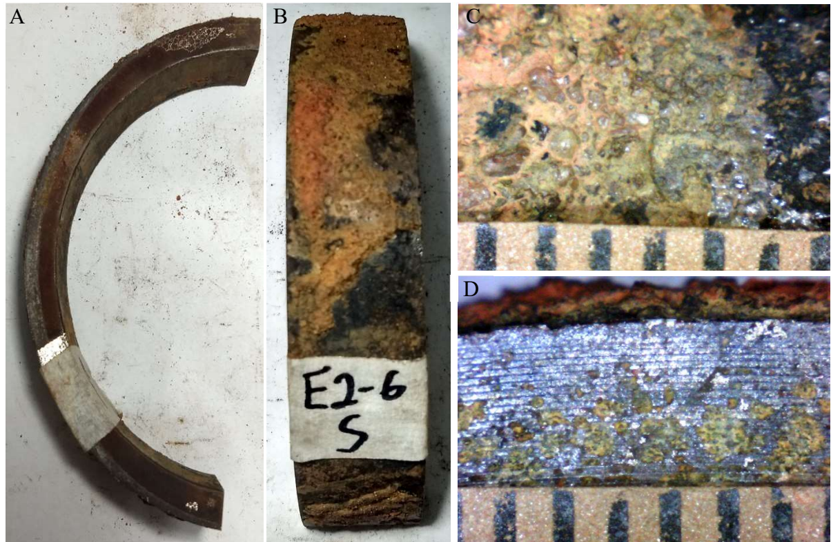
Figura 139 - Amostra E2-6-S não decapada, A) IC vista superior; B) IC vista externa; C) IM vista externa, escala 1mm; D) IM vista superior, escala 1mm
