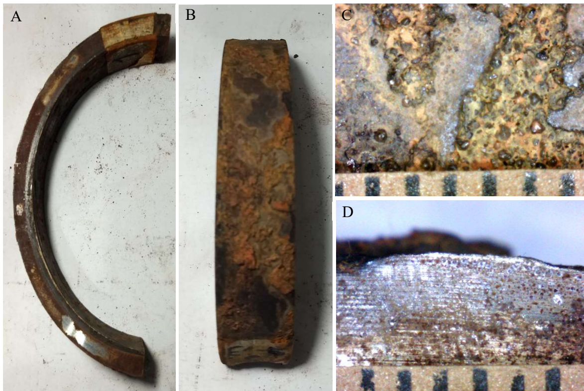
Figura 109 - Amostra E1-6-S não decapada, A) IC vista superior; B) IC vista externa; C) IM vista externa, escala 1mm; D) IM vista superior, escala 1mm
