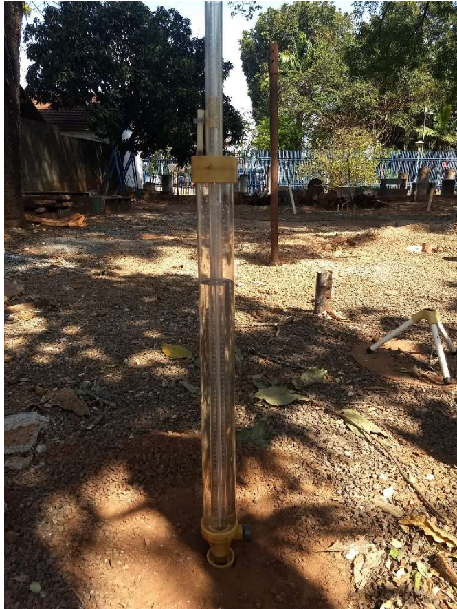
Figura 34 – Permeâmetro de Guelph instalado sem tripé
