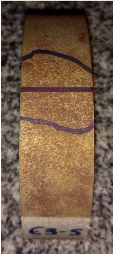
Figura 63 Amostra E3-S-2, que foi exposta às intempéries
