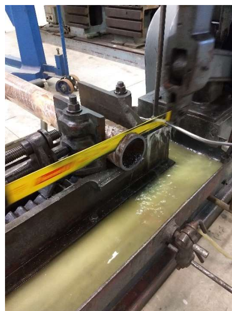
Figura 18 – Serra mecanizada extraindo amostras
