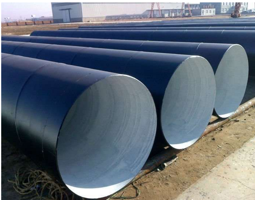
Figura 11 – Tubulação revestida com tinta epóxi alcatrão de hulha
