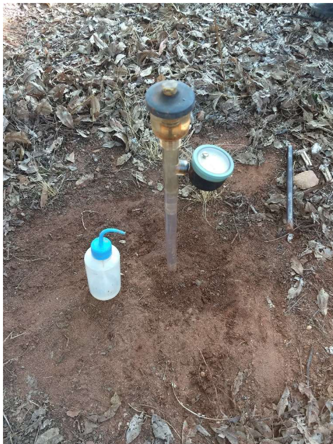
Figura 35 – Tensiômetro instalado para medir sucção em campo
