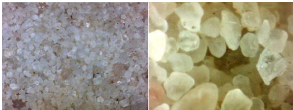
Figura 46: Morfologia dos grãos variando de angular a subangular
