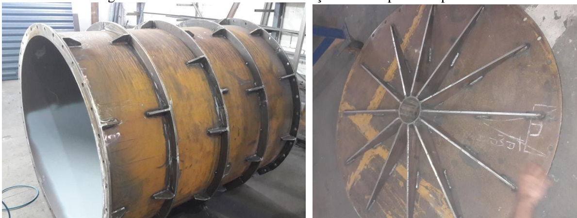
Figura 4.11: Foto da câmara de calibração e da tampa sem a pintura
