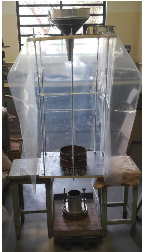
Figura 4.28: Foto do sistema de chuva de areia no ar com as alturas de queda e diâmetros pré-definidos
