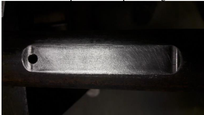
Figura 02: Afundamento da superfície e furo para a colagem dos extensômetros.
