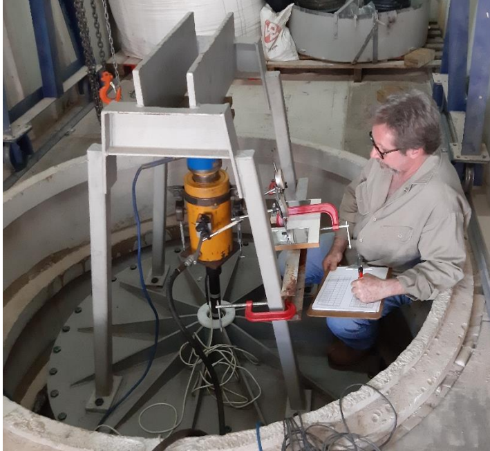
Figura 4.50: Registro dos deslocamentos nos ensaios de carregamento das estacas modelo.
