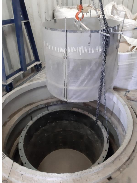
Figura 4.17: Chuveiro para deposição da areia na câmara de calibração
