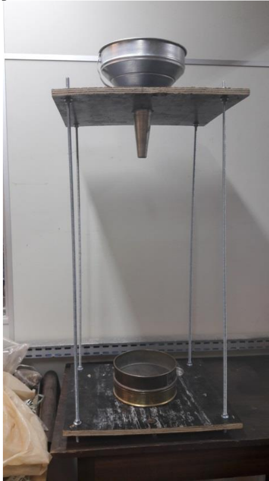
Figura 4.15: Foto do sistema de chuva de areia no ar
