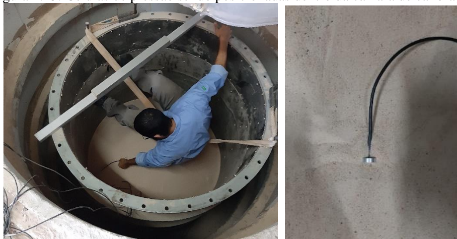
Figura 4.45: Células de pressão sendo posicionadas dentro da câmara de calibração
