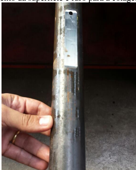
Figura 01: Afundamento da superfície e furo para a colagem dos extensômetros.
