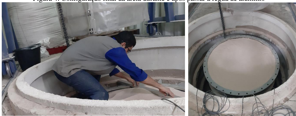
Figura 4: Configuração final da areia durante e após passar a régua de alumínio
