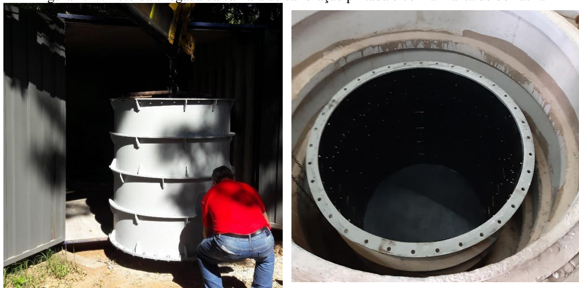
Figura 4.12: Foto da chegada da câmara de calibração pintada e com a manta de borracha
