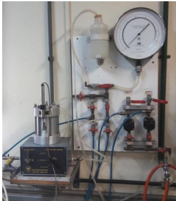
Figura 03: Painel do sistema triaxial e válvulas de controle de pressão.
