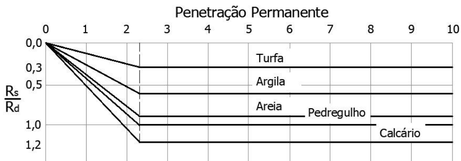
Figura 3.2: Relação entre o coeficiente \lambda e avanço do penetrômetro para diferentes tipos de solo
