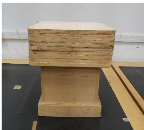
Figura 4. Banco de altura ajustável usado pelos participantes na tarefa de alcançar e pegar o objeto na posição sentada. A parte superior do banco é composta de lâminas de madeira que podem ser adicionadas ou removidas para ajustar a altura necessária para cada participante. As lâminas de madeiras são fixadas por parafusos longos nos quatro cantos.
