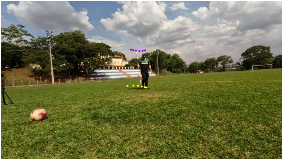
Figura 6 – Coordenadas de tela do bastão topográfico. Em roxo o topo do bastão e amarelo a base.
