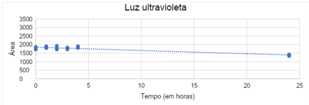
Gráfico 08– Perfil de degradação do propofol em exposição à luz UV na mistura, no tempo total de 24 horas. Analisado por CLAE-DAD-EM
