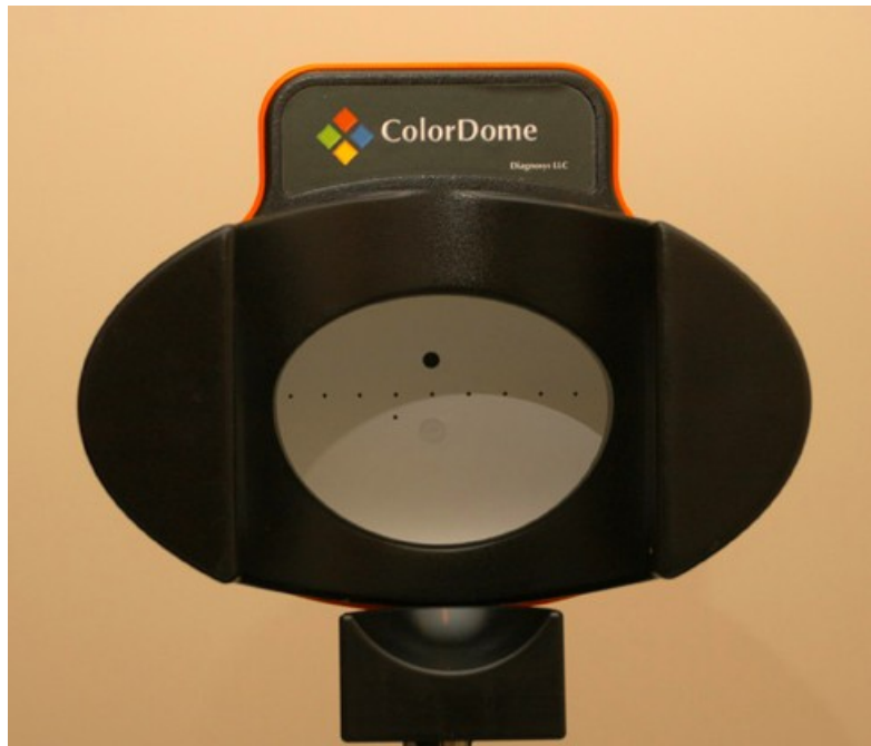
Figura 14 - Estimulador de LED do tipo Ganzfeld (cúpula de campo total)
