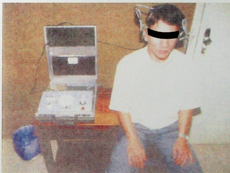
Figura 2: Imitânciômetro I28 da Rexton utilizado para a realização das Imitânciômetrias.
