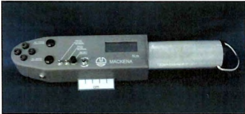
Figura 6 - Fotografia do torquímetro digital Mackena®, modelo MK-201 com capacidade de 10N.m e precisão de 0,01 N.m.
