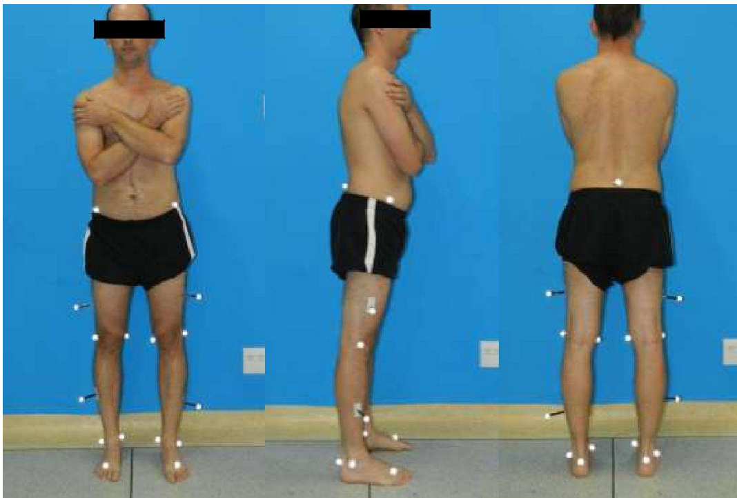
Figura 4 - Colocação dos marcadores refletivos de referência e de rastreamento nos pontos anatômicos
