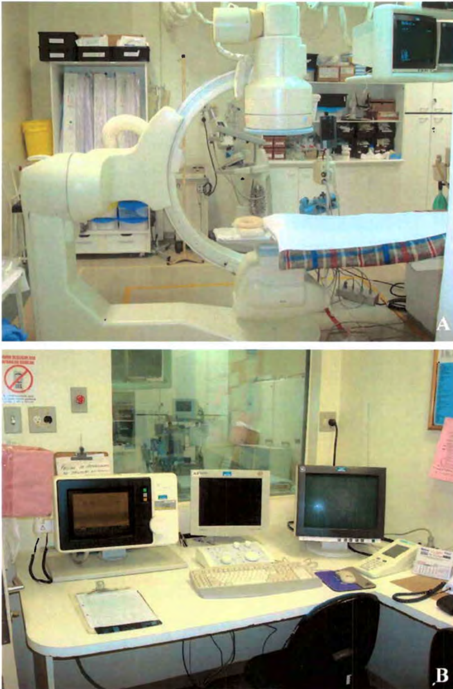
Figura 1: Fotografias de sala angiográfica atualmente disponível no HCRP-USP, instalada na Unidade de Emergência e localizada no bloco de radiologia geral. A) Arco monopiano do aparelho, que não possui tecnologia de aquisição de imagens tridimensionais. B) Painel de controle com apenas um monitor para visualização de imagens na sala de controle.
