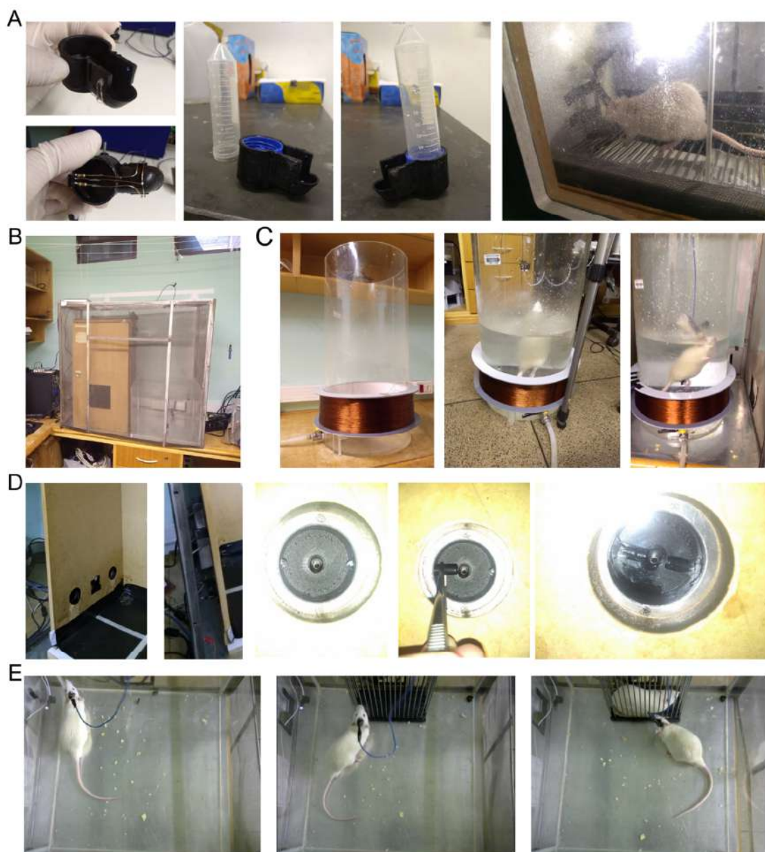
Figura 1 – Aparatos desenvolvidos. A , Dispositivo de entrega de recompensa e detecção de presença por infravermelho usado no artigo II. B , Sistema para registros comportamentais e eletrofisiológicos com a caixa familiar (esquerda) e campo aberto (direita). C , Sistema de indução eletromagnética (ímã-bobina) usado para registro comportamental no nado forçado. Note o elástico na pata do rato e a impermeabilização. D , Detectores de lambida por feixe de infravermelho inseridos na caixa familiar. E , Exemplo de configuração durante as etapas do teste de interação social. Note o LED infravermelho no canto superior esquerdo usado para sincronização com registro eletrofisiológico.
