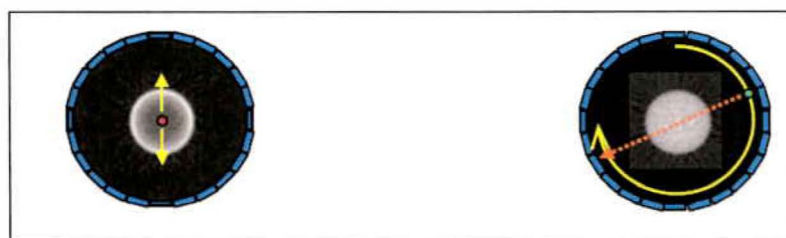
Figura 2 - Scan de emissão não corrigido (esquerda) e scan de emissão corrigido (direita).
