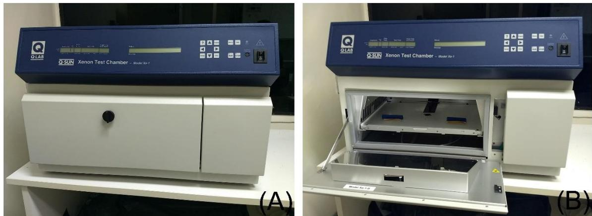
Fonte: elaborada pela autora. (A) simulador solar de amplo espectro. (B) parte interna do simulador, onde as placas foram dispostas para exposição à radiação.
