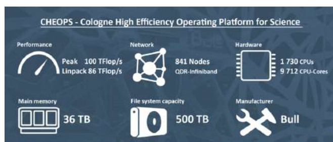
Figura 14 – Especificações do CHEOPS , servidor utilizado para rodar as análises de CPPC. Destacando 500 TB de armazenamento, 1.730 CPUs e 9.712 CPU-Cores .
