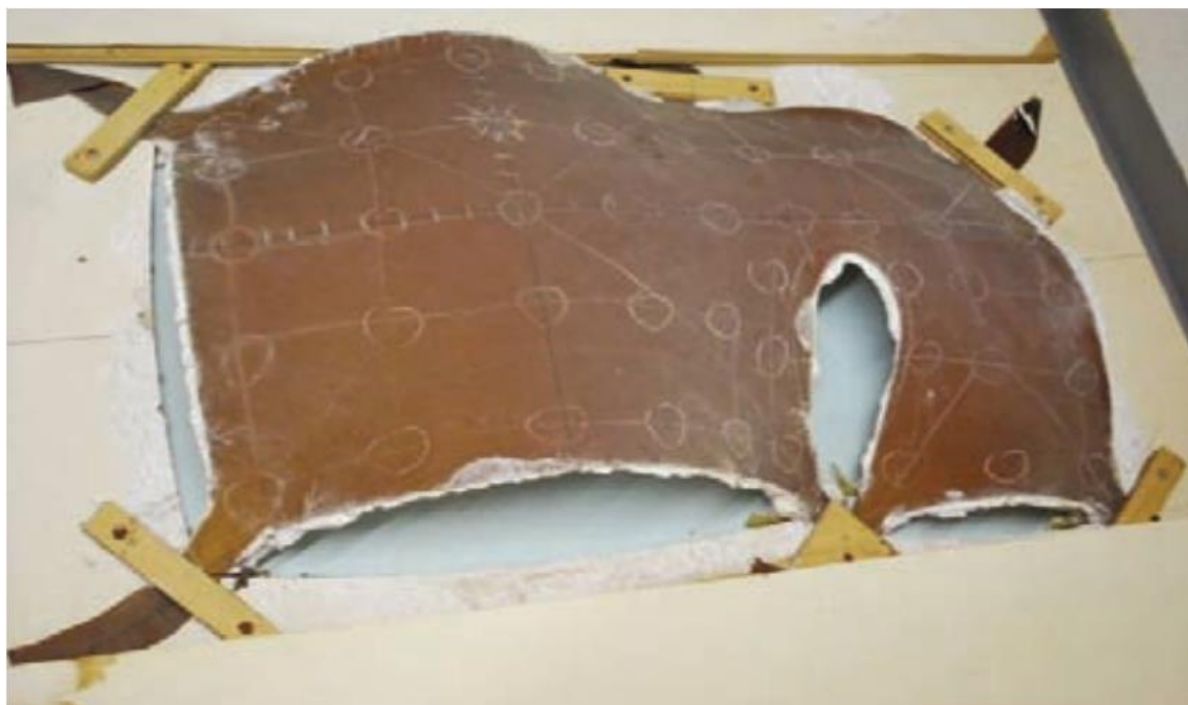
Figura 57 Modelo em látex e gesso da fábrica Sicli AS Fonte: (CHILTON 2012).
