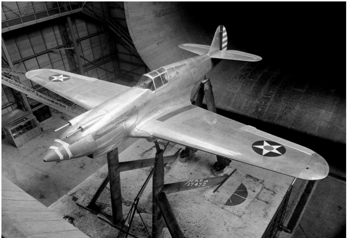
Figura 50 Curtiss XP-40 no túnel de vento Fonte: NASA (1939).
