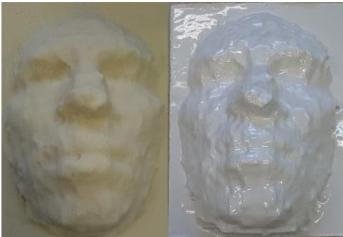
Figura 89 Molde de Poliuretano sem e com Gelacoat Fonte: Elaboração Própria
