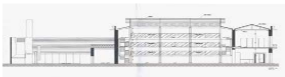
Figuras 78 e 79: Biblioteca Pública Cassiano Ricardo, São José dos Campos. Guilherme Motta e Antonio Luiz Dias de Andrade, 1995-1996. Acima: corte longitudinal. À esquerda: corte transversal mostrando a estrutura interna.
