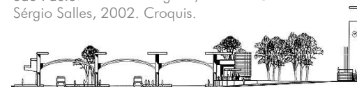
Figura 49. Terminal de Ônibus Urbanos na Lapa, São Paulo. Luciano Margotto, Marcelo Ursini e Sérgio Salles, 2002. Corte mostrando a estação, a praça e a caixa d’água. Fonte: www.arcoweb.com.br
