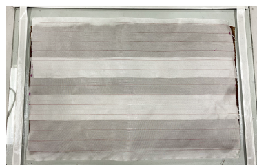
Etapa 3 - Aplicação do tecido desmoldante "peel ply"
