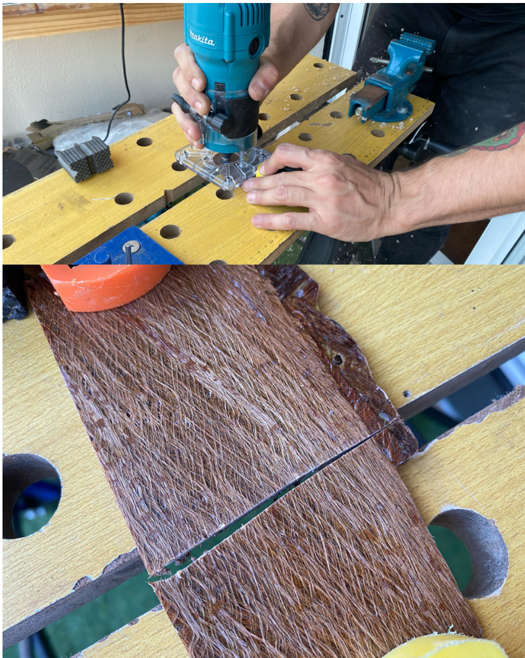
Fig. 83 - Corte da placa de compósito com serra circular manual
