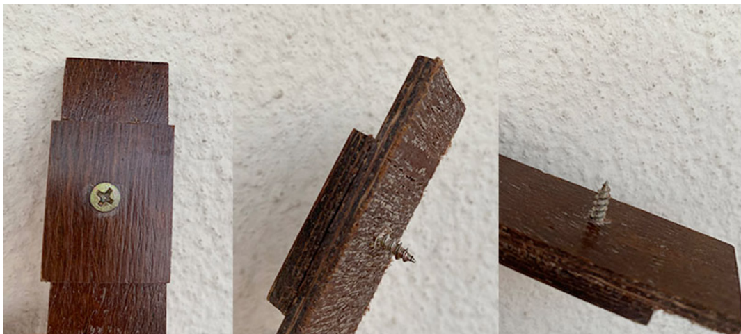
Fig. 88 - Análise visual de escareamento e inserção de parafuso
