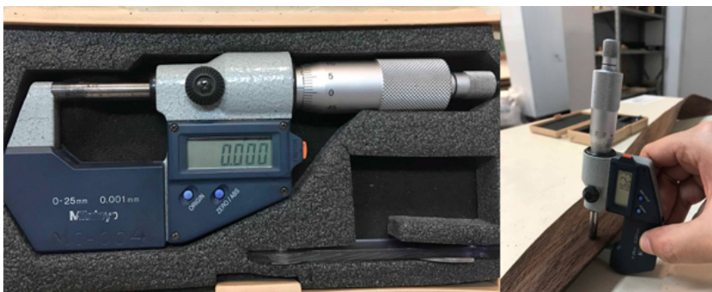
Fig. 48 - Micrômetro utilizado para medição da espessura
