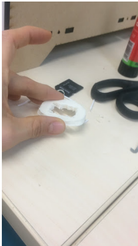
Figura 69. Uma das tentativas de impressão: desalinhamento e quebra da peça. Fonte: Autora.
