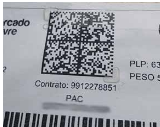
Figura 27/5. Aplicação do QR-code tátil sobre código QR impresso.
