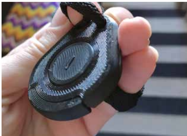
Figura 33/5. Protótipo impresso em 3D, com cadarço substituindo fita do colar.
