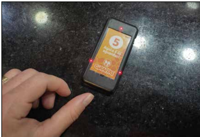
Figura 31/5. Dispositivo vibratório luminoso típico em lanchonetes.
